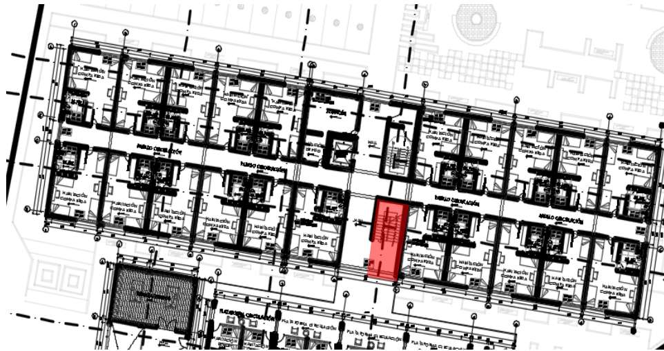
Figura 81: Escalera de evacuación
