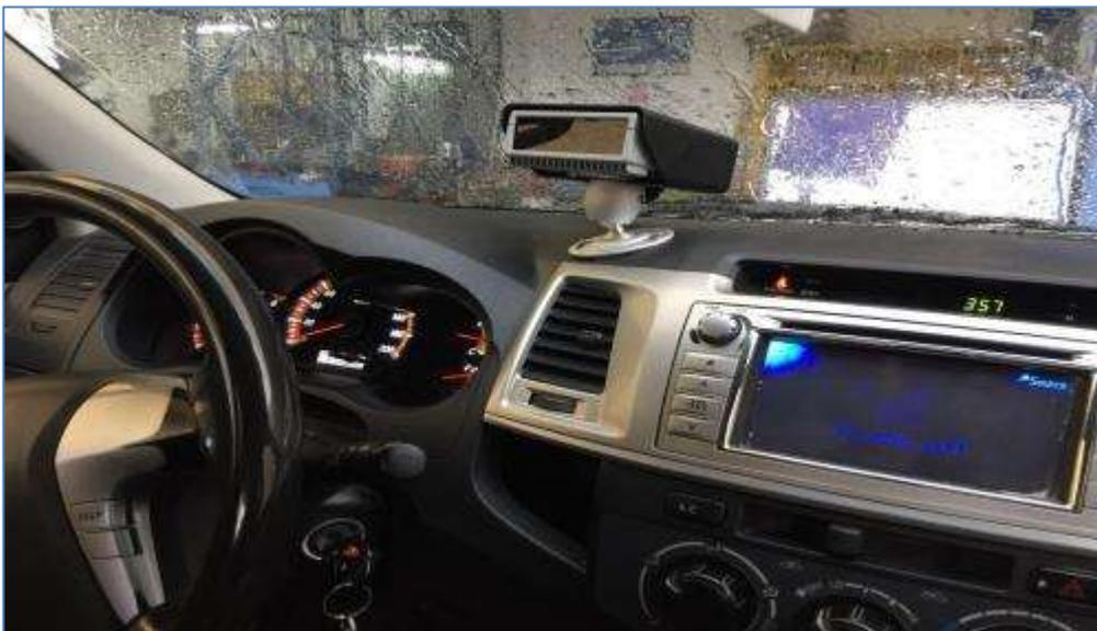
Figura 19. Sensores de control de fatiga.
