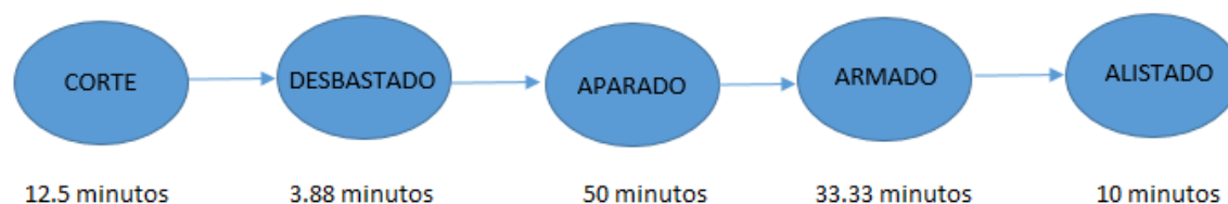
Figura 6. Tiempos de las operaciones en las líneas del proceso antes de mejora
