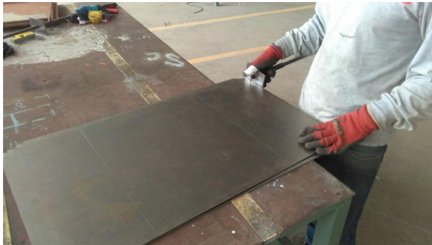
Figura 10. Trazado de planchas de acuerdo con el plano y el diseño.
