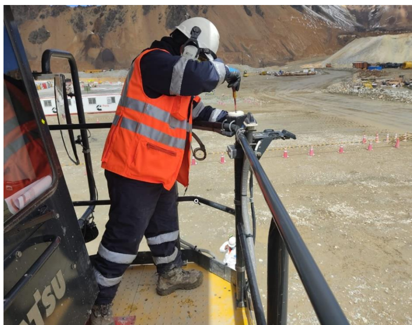
Figura 12. Inspección de antena GPS y cableado
