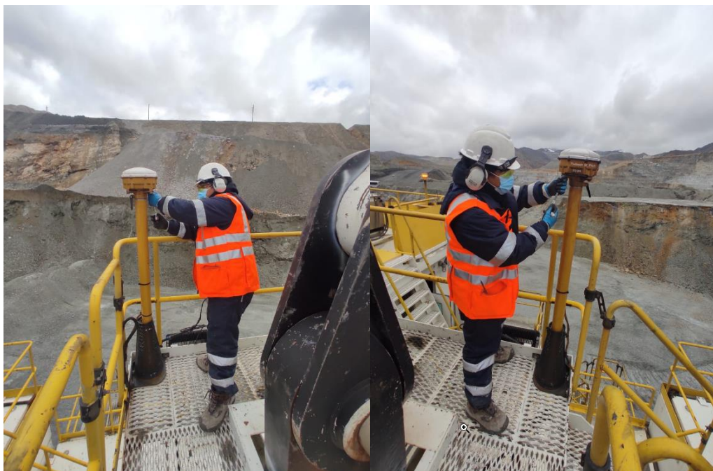
Figura 19. Inspección de antenas GPS's
