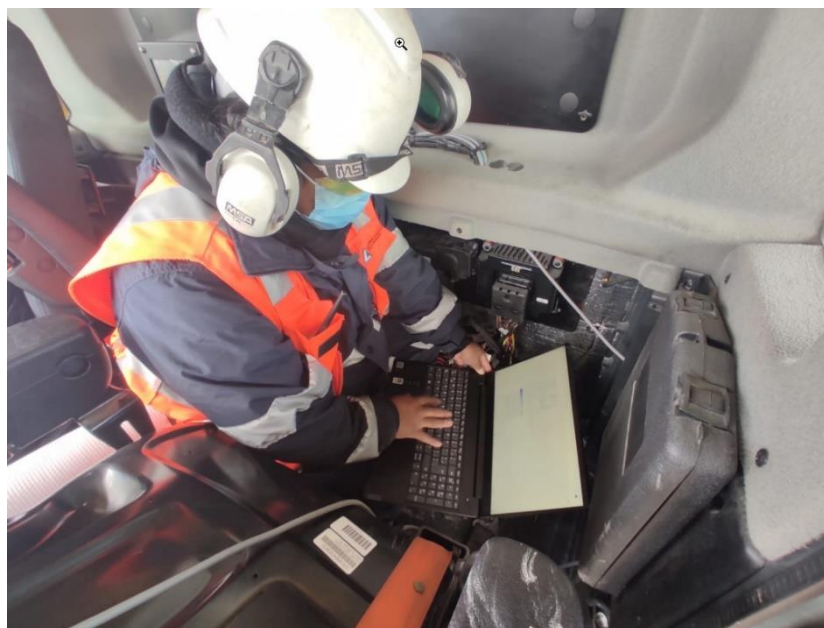
Figura 11. Inspección y flasheo de ECM y Receptor GPS
