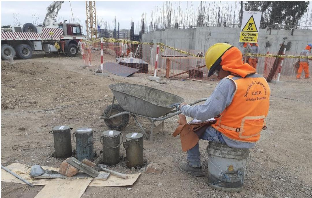
*Figura 54: Toma de muestra de probetas*
