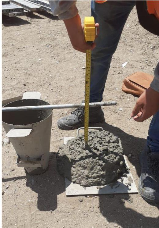
*Figura 53: Ensayo del Cono de Abrams*
