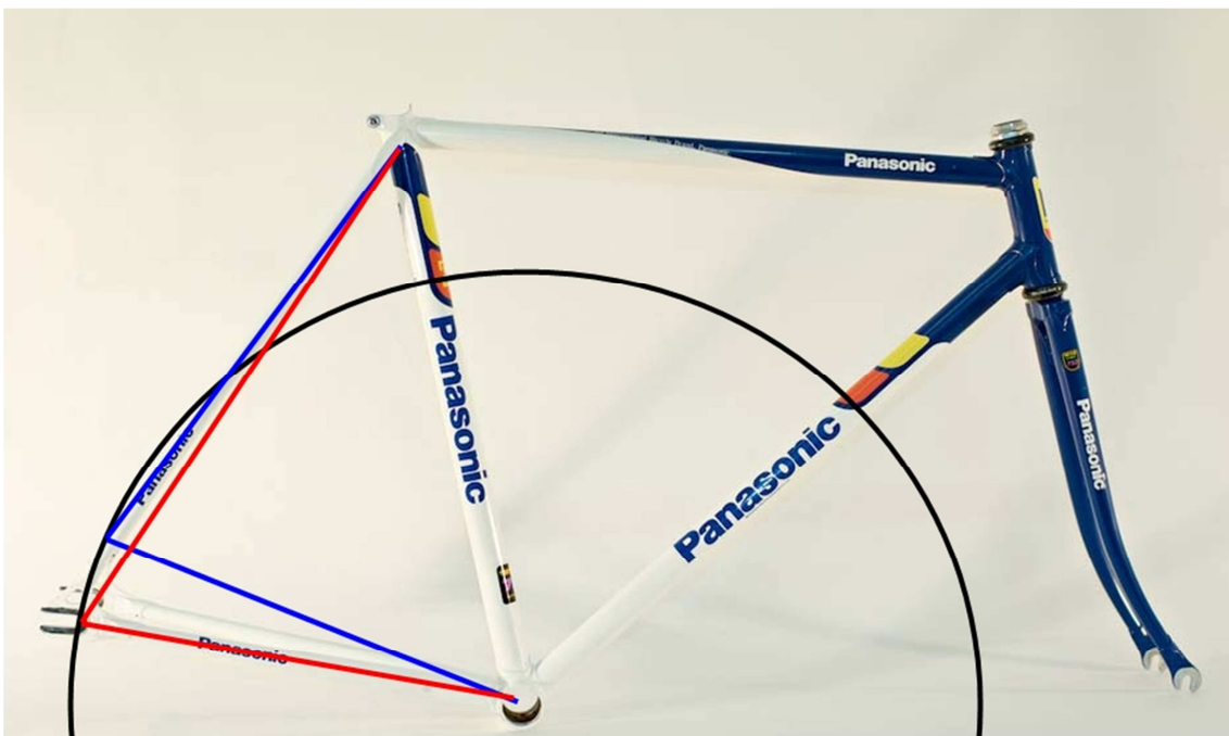
Figura 29 - Demostración de la reducción de peso variando la geometría
