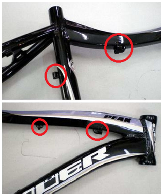
Figura 30 - Vista de la soldadura de final de cable
