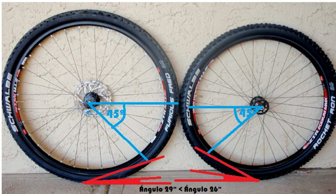
Figura 37 - Vista del ángulo de ataque de las ruedas de 26 y 29 pulgadas
