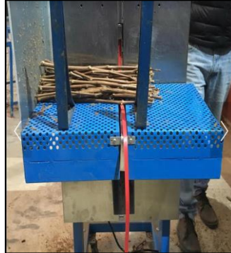
Figura 4. Máquina flejadora, es el activo de producción que se usará para realizar los amarres de injerto.
