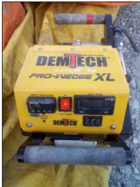
Figura 20. Máquina de soldar geomembrana.
