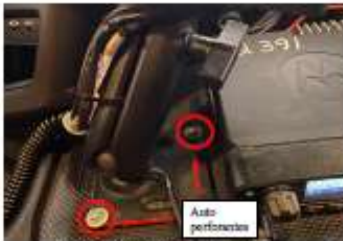
Ilustración 13: Instalación de base RAM
