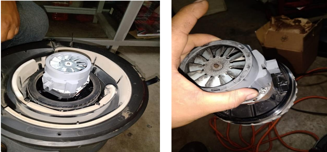
Figura 46. Mantenimiento correctivo de la aspiradora
