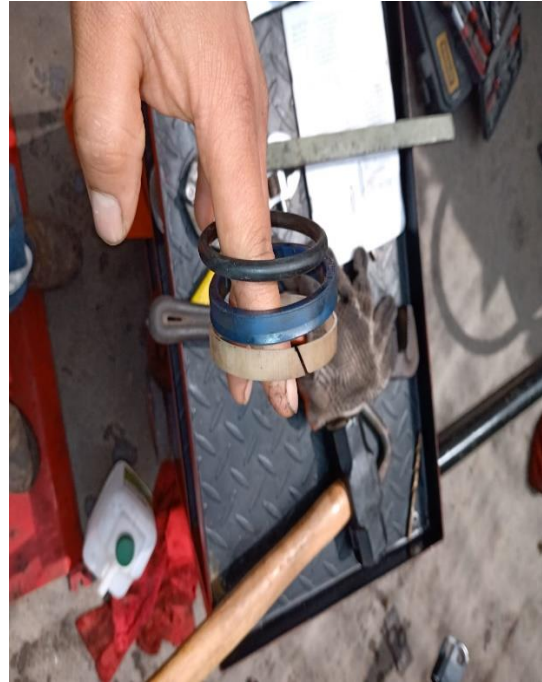
Figura 45. Mantenimiento correctivo del elevador hidráulico con desmontaje de pistones
