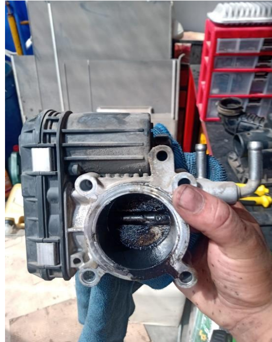
Figura 19. Obturador antes de realizar el mantenimiento preventivo
