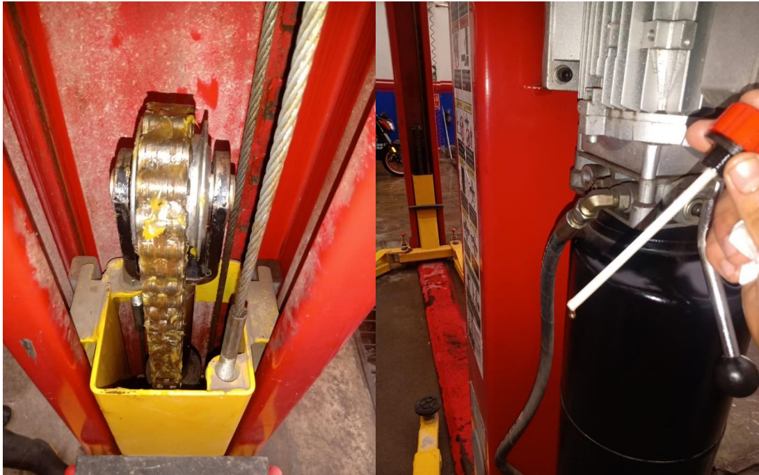
Figura 38. Mantenimiento preventivo elevador hidráulico
