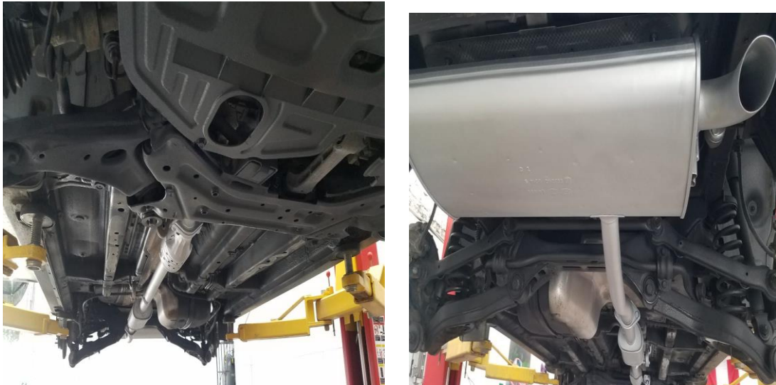
Figura 23. Chasis despues del procedimiento Undercoating
