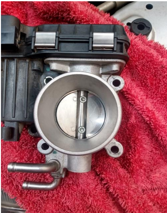
Figura 20. Obturador luego de realizar el mantenimiento preventivo
