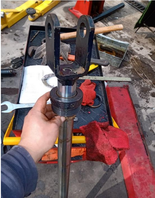
Figura 45. Mantenimiento correctivo del elevador hidráulico con desmontaje de pistones
