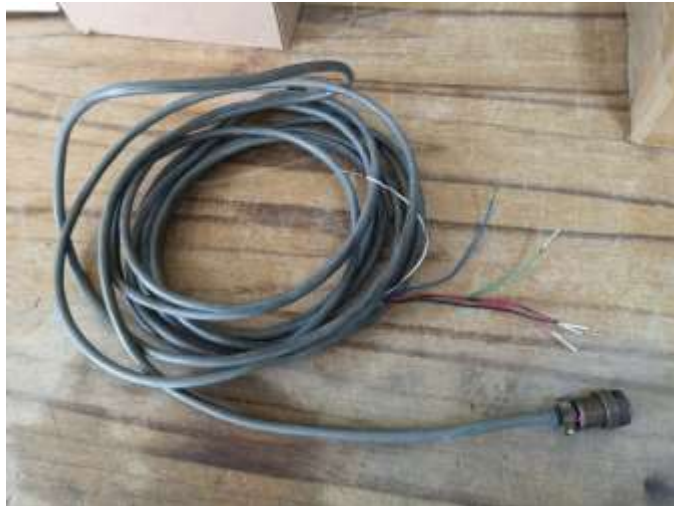
Figura 34. Cable Conexión VIM
