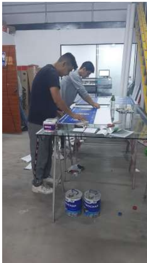
Figura 8. Condición insegura de trabajo: Falta de equipos de protección personal, exposición a agentes tóxicos. Fuente: Jomigraf Group, S.A.C. (2021).
