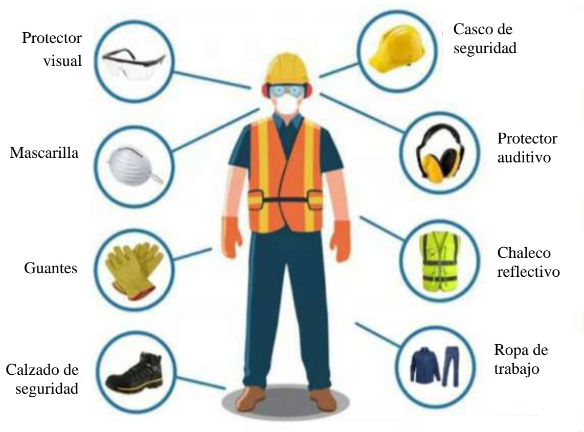
Figura 14. Esquema de los equipos de protección personal (EPP) seleccionados para la empresa. Fuente: Solís, S.A. (2019)
