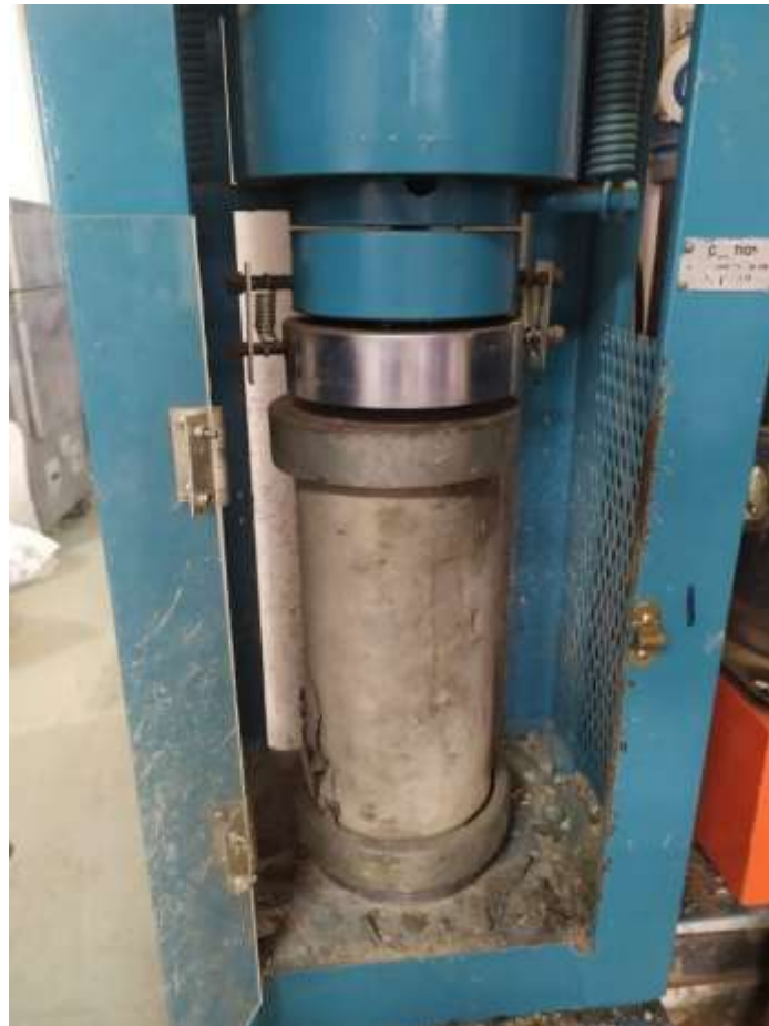
Rotura de probeta cilíndrica a compresión
