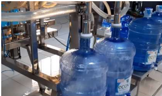
Figura 10. Proceso de llenado de bidones. Fuente: Empresa GRUPO EJ S.R.L.
