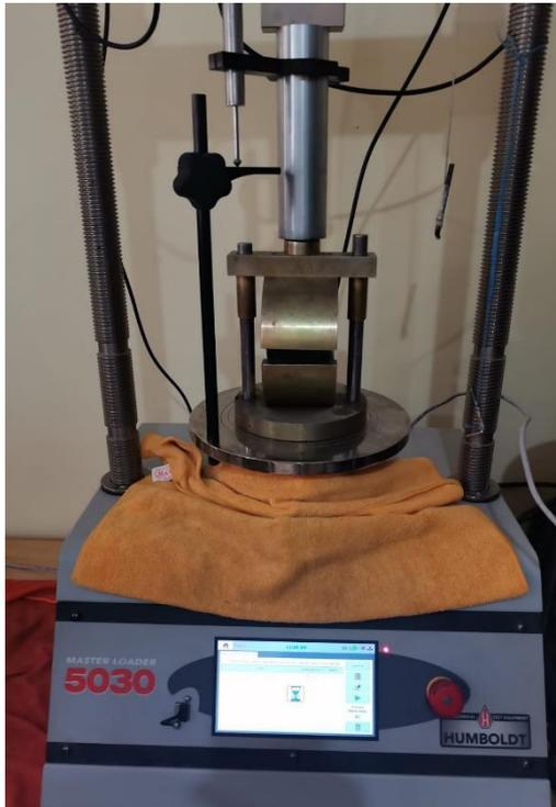
Fuente: Ruptura de briquetas Marshall
