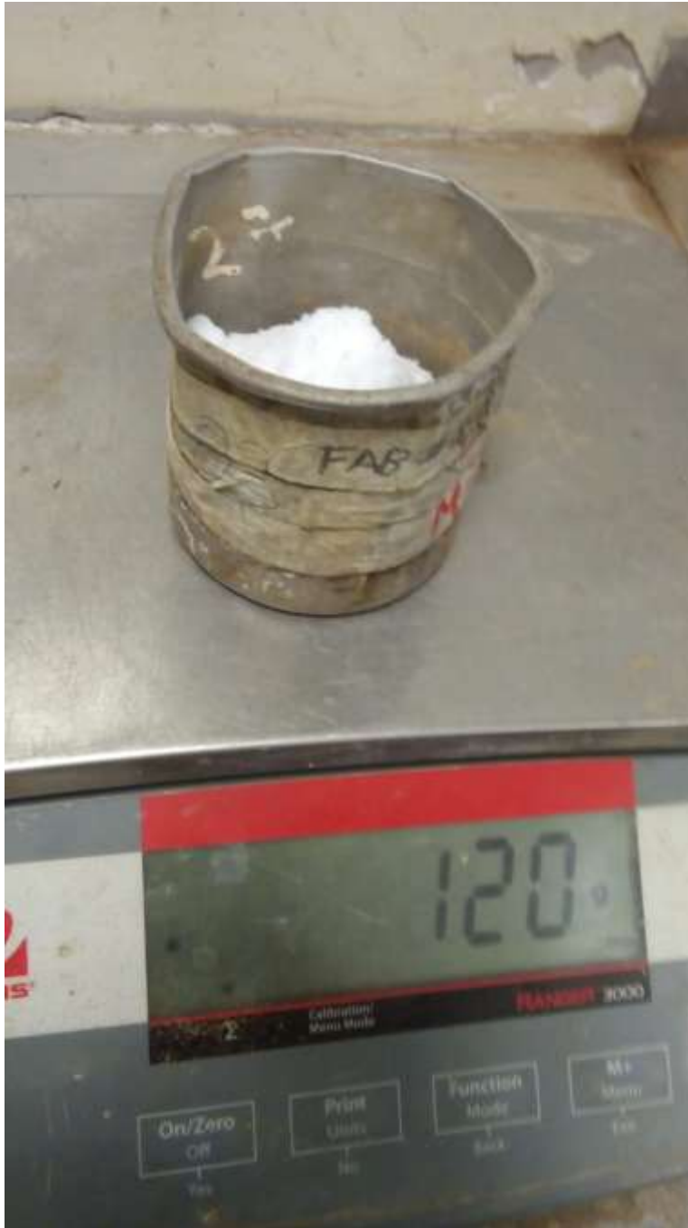
Figura 113: Pesado de Cloruro de magnesio para mejoramiento
