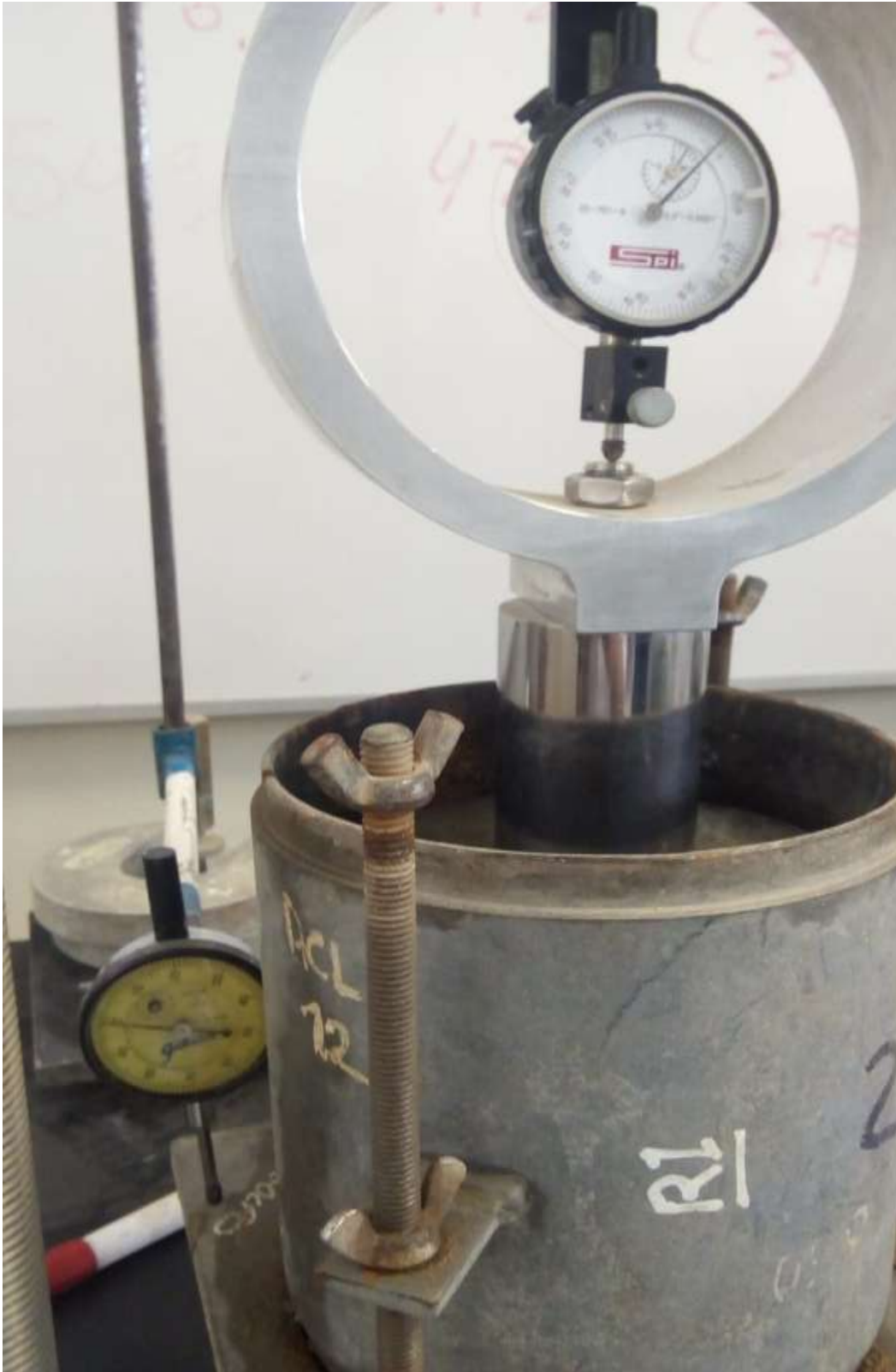
Figura 118: Ensayo de CBR
