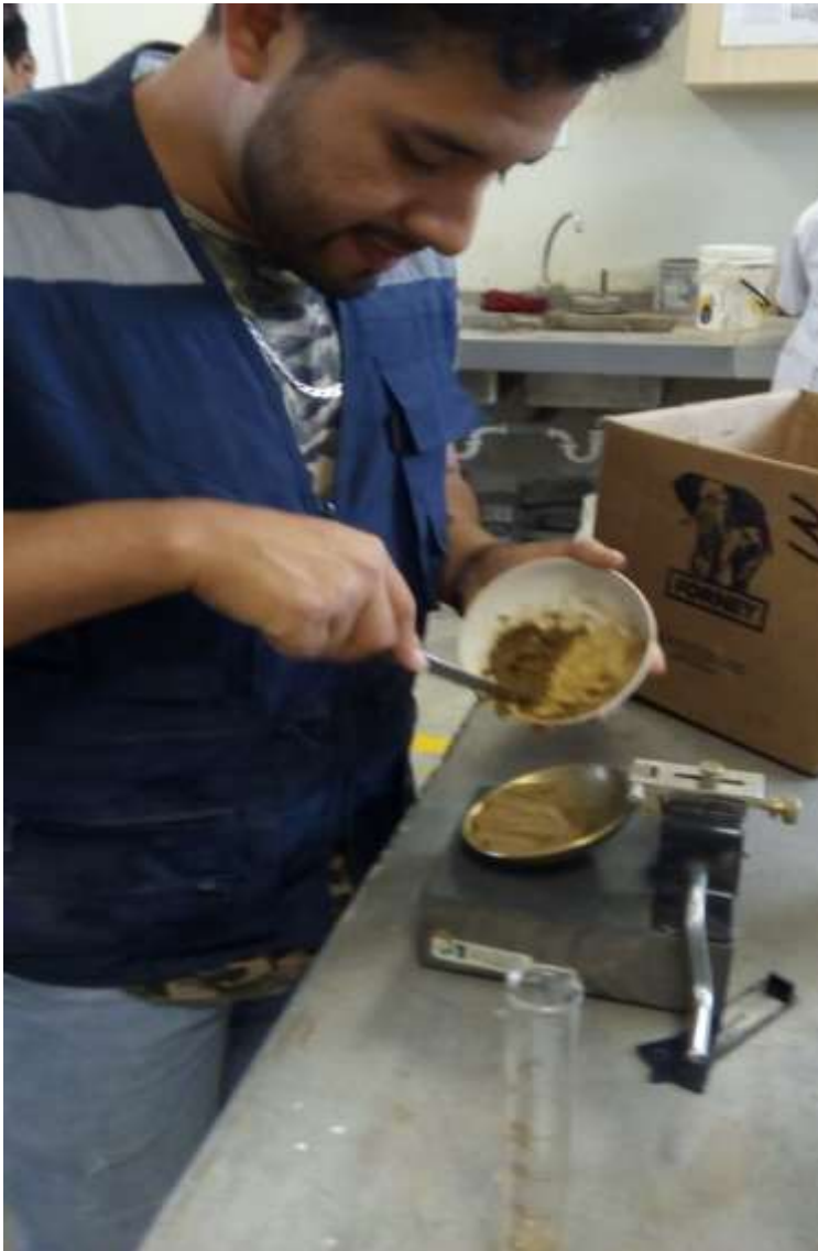
Figura 111: Ensayo de la copa de Casagrande
