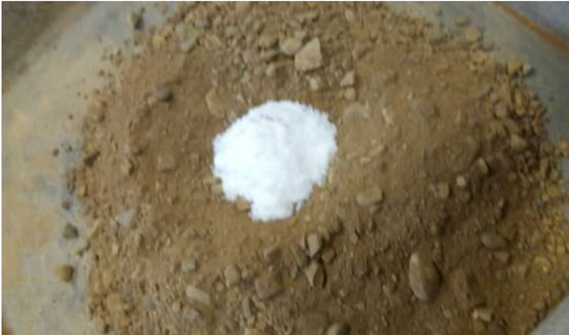
Figura 114: Adición de cloruro de magnesio en el material a estabilizar
