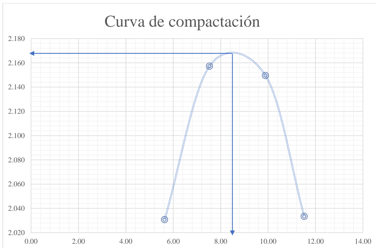
Figura 39: Curva de Densidad vs Contenido de Humedad al 2% de MgCl 2 de C-03
