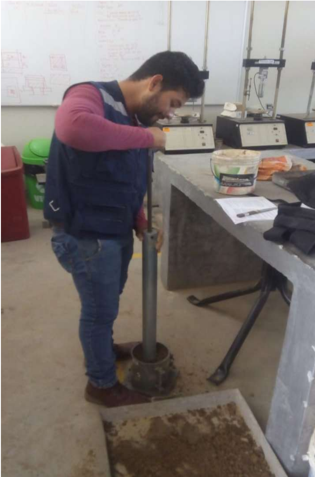
Figura 119: Prueba de compactación de Proctor modificado
