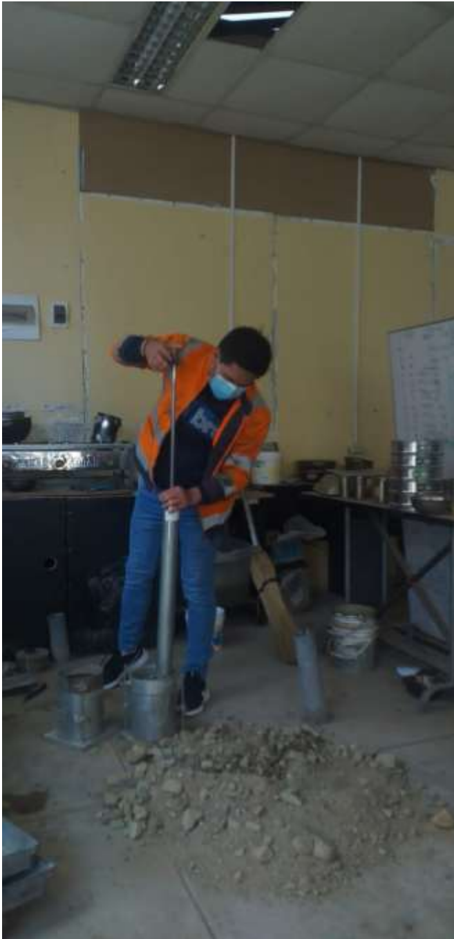
Figura 122: Prueba de Proctor modificado en HIDROGEOMIN
