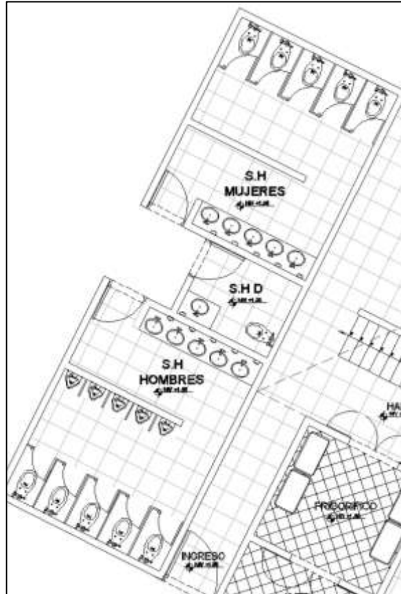
Imagen 5 Batería de baños público mercado- típica
