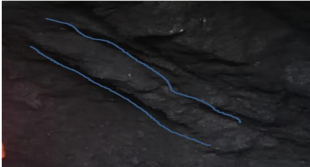
Figura 6. Alteración de la discontinuidad, mapeo geomecánico de las galerías
