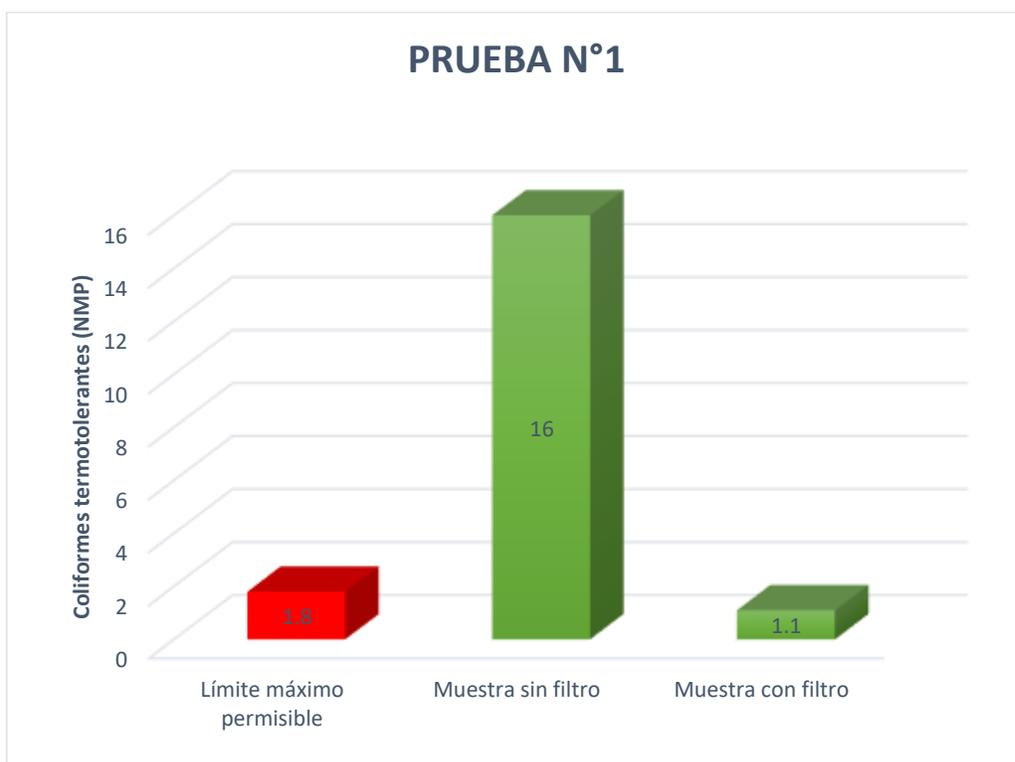
*Nota:* Elaboración propia basada en resultados del laboratorio. Figura 18 se describe los resultados obtenidos de Coliformes termotolerantes (NMP) de la prueba N°1, las barras de color rojo representan el límite máximo permisible, la de color verde la muestra sin filtro y la de color celeste la muestra con filtro la que nota una mejora.
