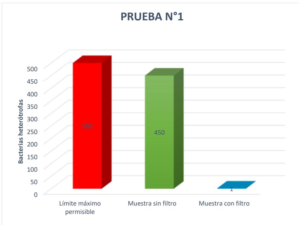
*Nota:* Elaboración propia basada en resultados del laboratorio. Figura 12 se describe los resultados obtenidos de bacterias heterótrofas de la prueba N°1, las barras de color rojo representan el límite máximo permisible, la de color verde la muestra sin filtro y la de color celeste la muestra con filtro la que nota una mejora.
