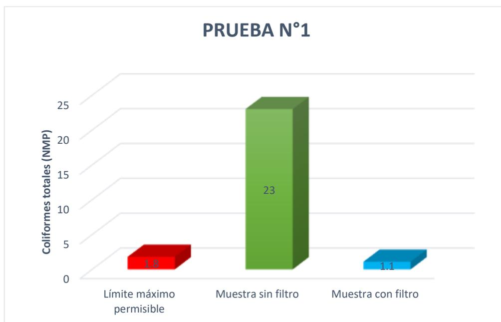
*Nota:* Elaboración propia basada en resultados del laboratorio. Figura 10 se describe los resultados obtenidos de coliformes totales (NMP) de la prueba N°1, las barras de color rojo representan el límite máximo permisible, la de color verde la muestra sin filtro y la de color celeste la muestra con filtro.
