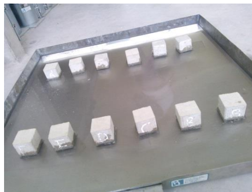
Figura 4. Ensayo de capilaridad de los morteros cemento/arena
