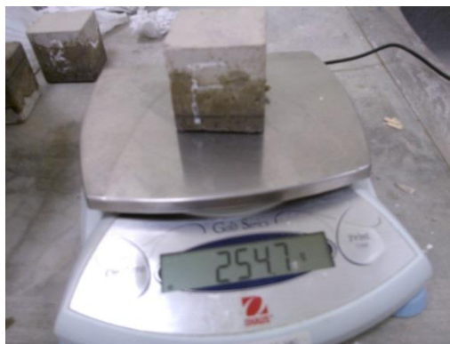
Figura 5. Pesado de muestras para la determinación del peso absorbido por capilaridad
