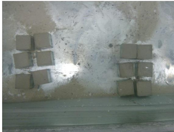
Figura 3. Curado de las probetas de mortero cemento/arena
