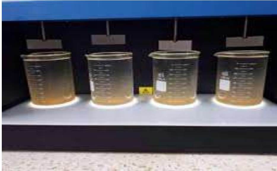
Figura 16. Ensayo de Jarras para 4 muestras
