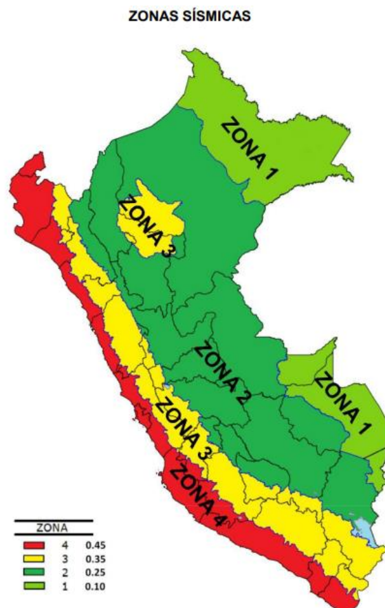
Figura 65. Zonificación por grado de sismicidad.
