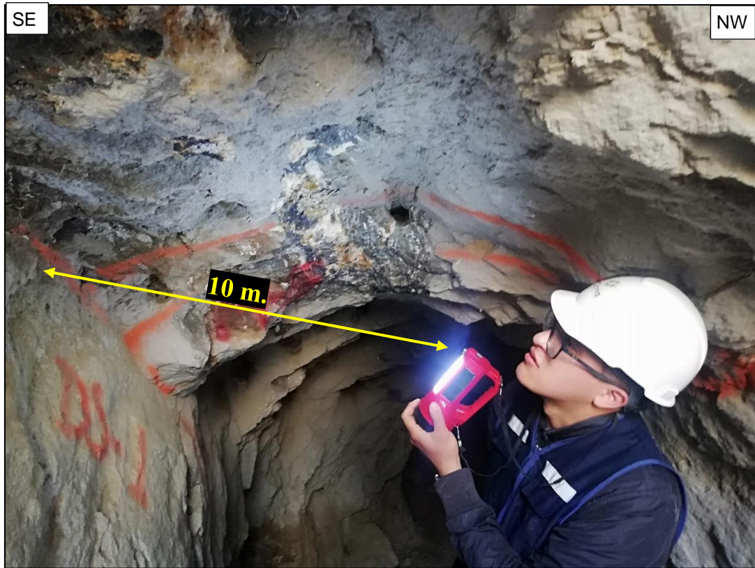
Figura 7. Lineal para medir RQD. Fuente: Elaboración propia, (2021).
