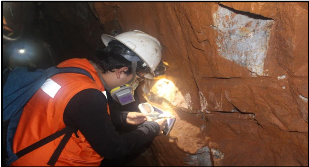
Figura 7: Toma de datos de Rumbo y Buzamiento de discontinuidades.
