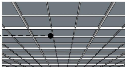
Losa con estructura de madera colocada de forma reticular
