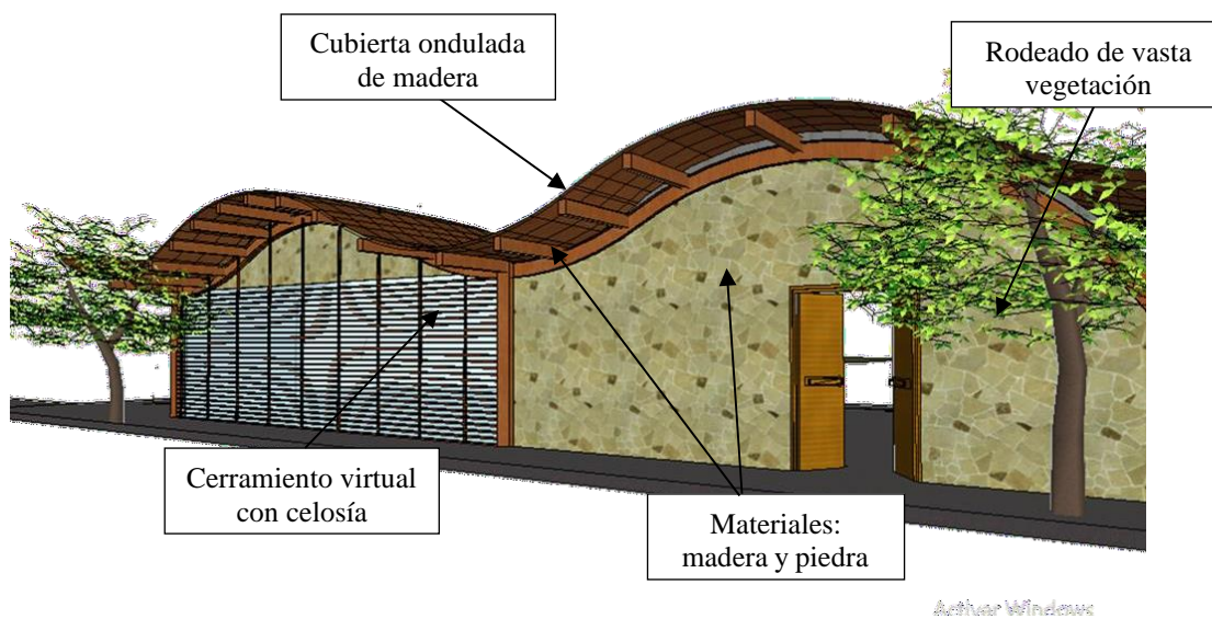
Figura 15. 3D de la fachada en el caso 1.
