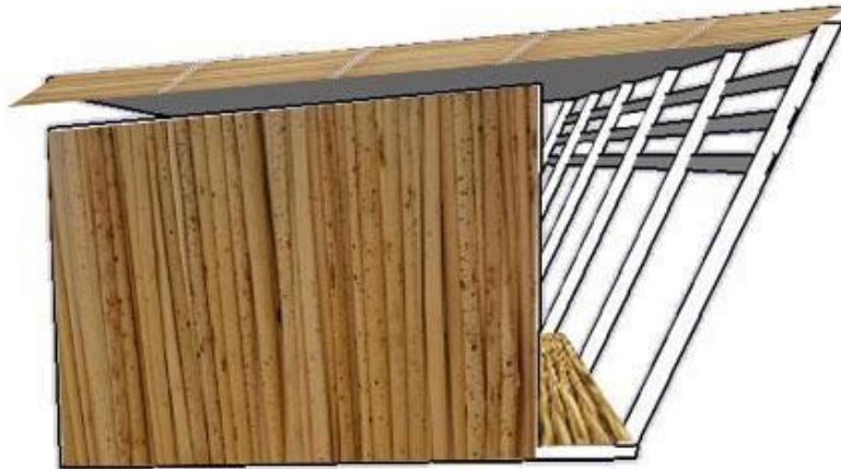
Figura 48. Revestimiento y cubierta de totora
