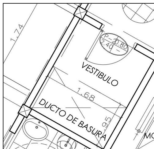
Figura 77. Ducto de basura.
