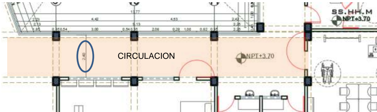
Figura 81: Ancho de circulación-Norma A-120
