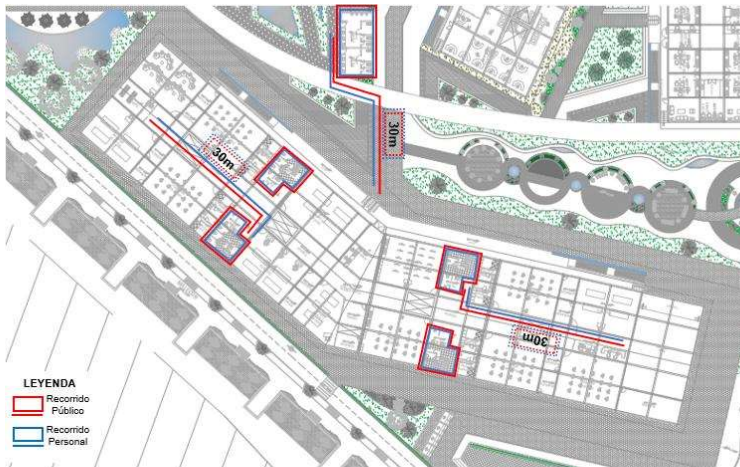
Figura n.ª 5.16. Dosificación de servicios sanitarios para público y personal teniendo en cuenta la distancia máxima reglamentaria – Zona Formación Cultural - Talleres
