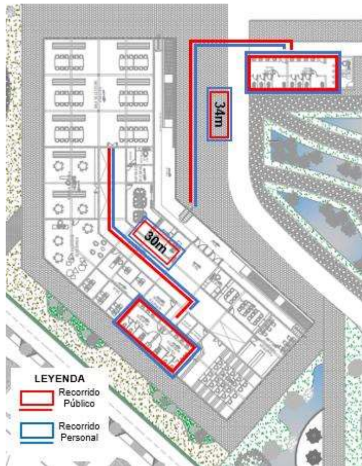
Figura n.º 5.18. Dosificación de servicios sanitarios para público y personal teniendo en cuenta la distancia máxima reglamentaria – Zona de Formación Cultural - Biblioteca
