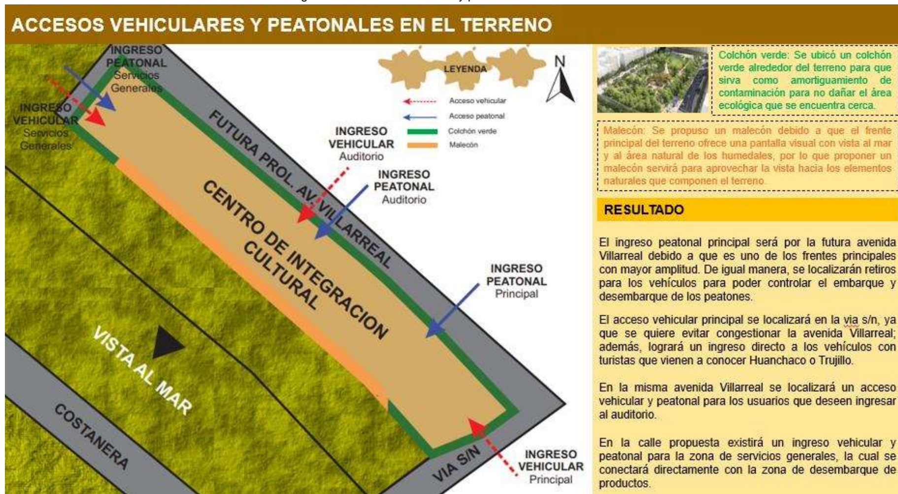
Figura 78. Accesos vehiculares y peatonales en el terreno
