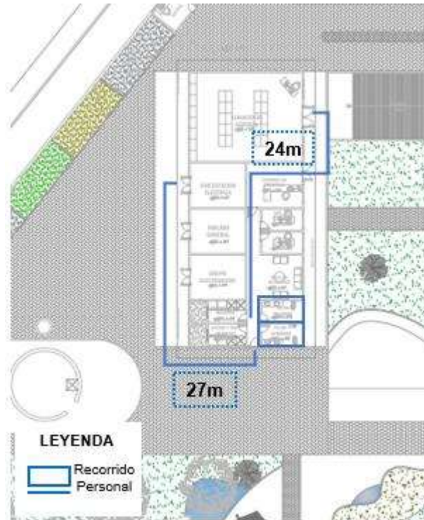
Figura n.º 5.16. Dosificación de servicios sanitarios para público y personal teniendo en cuenta la distancia máxima reglamentaria
