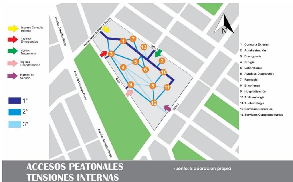
Con el análisis de tensiones internas se empezó a ubicar y relacionar todas las zonas, según su funcionamiento, flujo y diferentes tipos de circulaciones que hay en un hospital.
