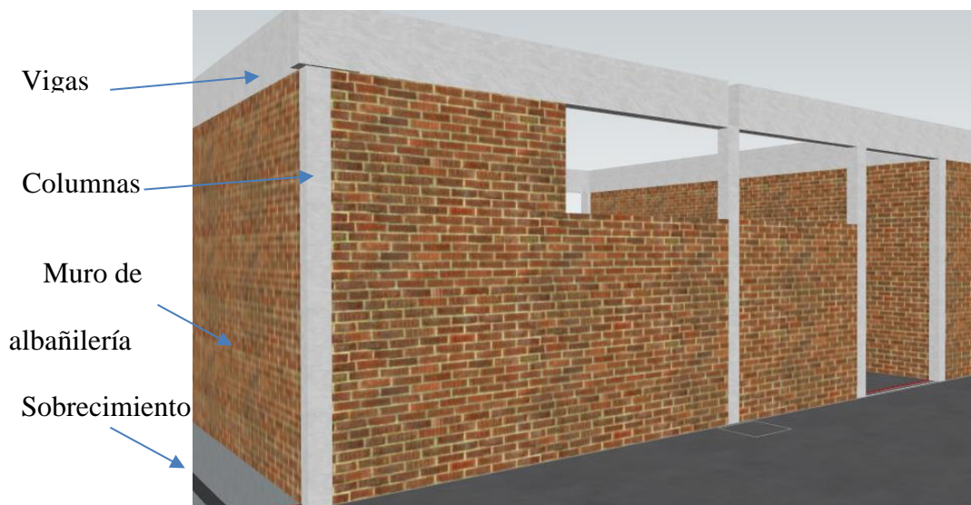
Figura 21. Estructura cuarto caso
