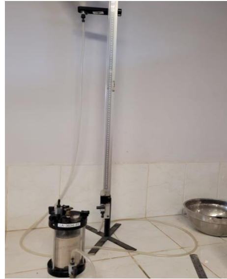
Foto N° 2: Equipo de permeabilidad ensamblado.
