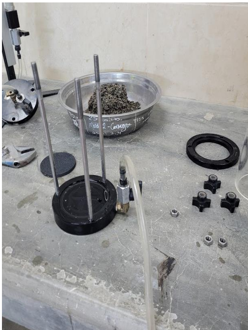
Foto N° 3: Armado del equipo de permeabilidad.
