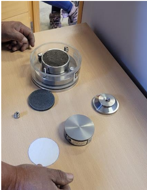
Foto N° 3: Armado del molde de consolidación con la muestra.
