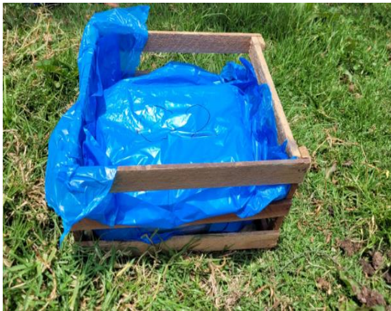
Foto N° 13: Protección de la muestra inalterada.
