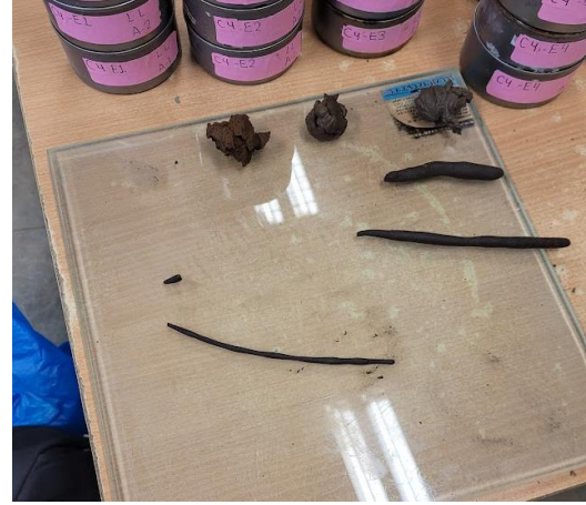
Foto N° 2: Muestra en forma de cilindros que presentan agrietamientos.
