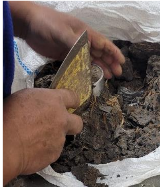
Foto N° 2: Tallado de la muestra para el ensayo.
