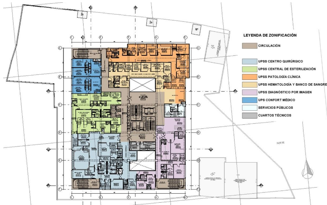
FIGURA N°109 – ZONIFICACION TERCER NIVEL
