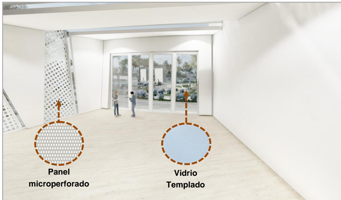
Figura 4.19. Materiales en Cerramientos
