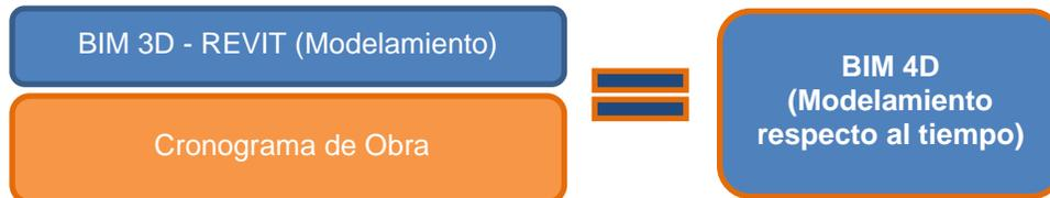
Ilustración 4: Explicación básica BIM 4D
