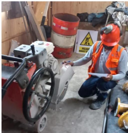
*Nota.* En la figura se presenta al trabajador quien es él que usa la herramienta de poder realizando la inspección antes del uso de la cortadora de pista.
