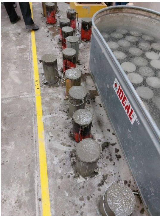
Colocación de concreto en probetas
