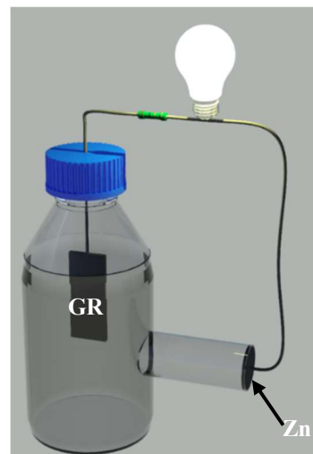
Fig. 1: Esquema del prototipo de las celdas combustible microbiana.
