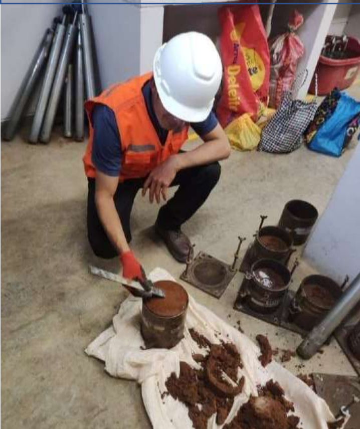
Ensayo De CBR
