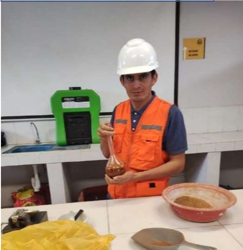
Ensayo de densidad específica del suelo
