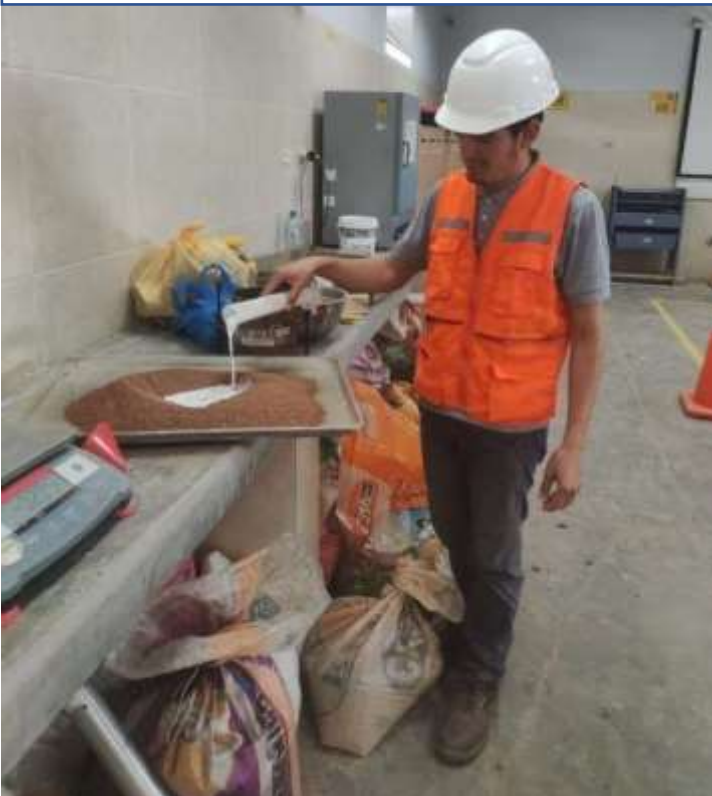
Ensayo De CBR adicionando aditivo
