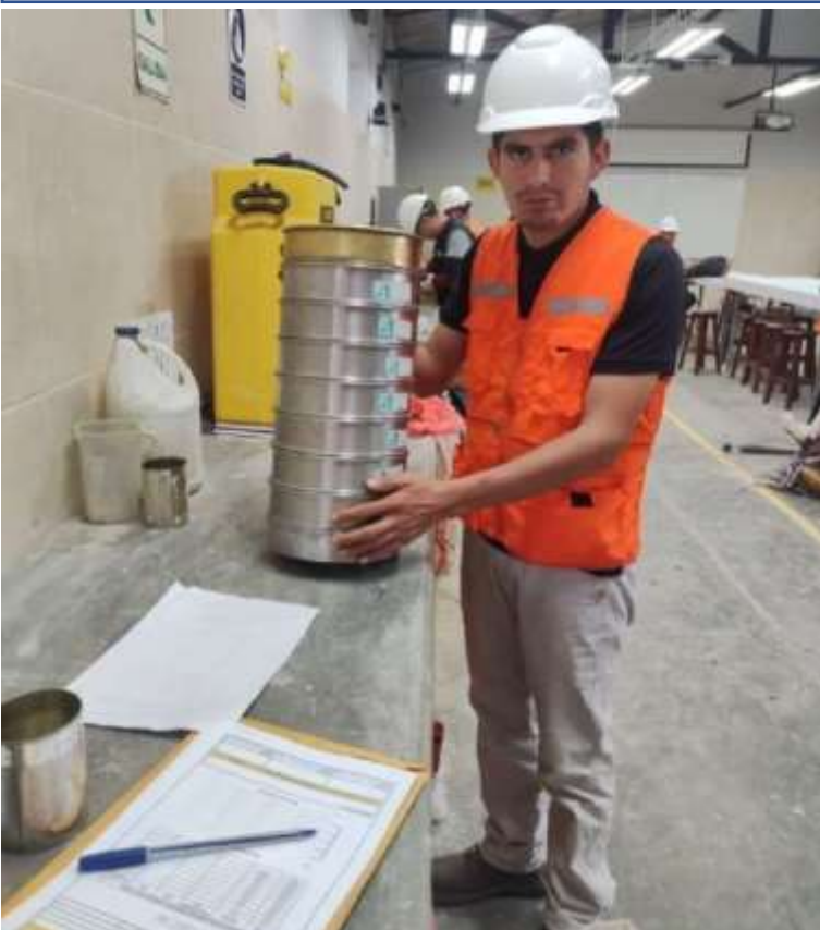
Tamizado para obtener los diferentes pesos de las mallas
