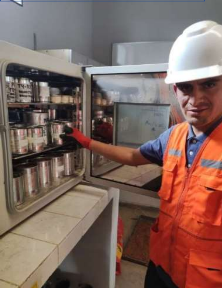
Colocación de taras al horno
