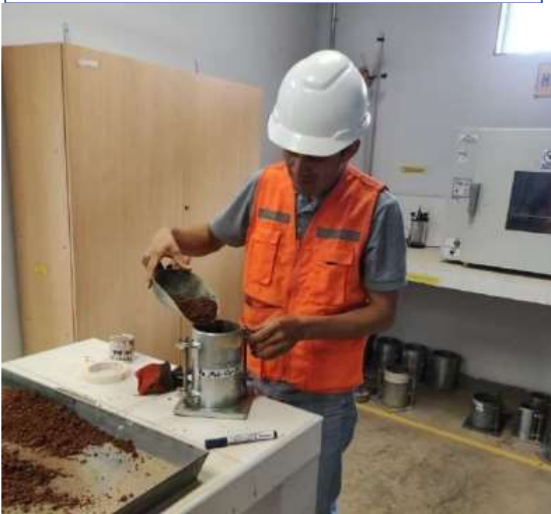
Ensayo de Proctor modificado
