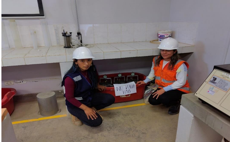
Fotografía N°20: Ensayo de CBR fase de Hinchamiento.
