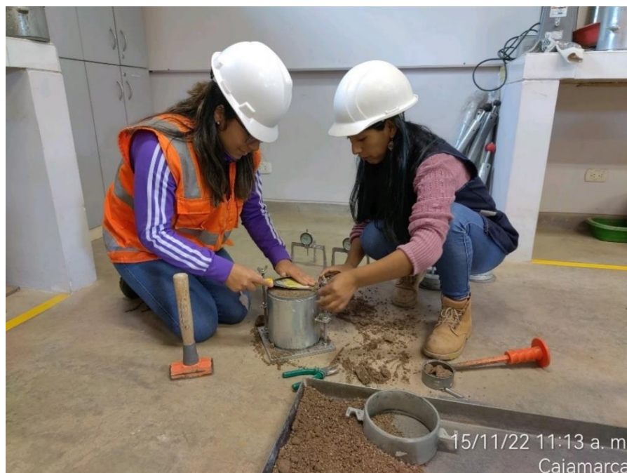
Fotografía N°18: Enrasado del ensayo de CBR.
