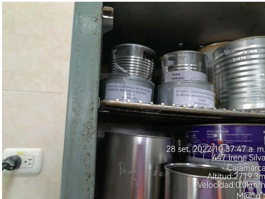
Fotografía N°04: Muestras codificadas en horno para el ensayo de contenido de humedad.
