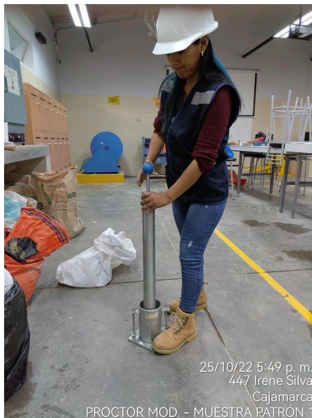
Fotografía N° 16: Compactacion del ensayo de Proctor Modificado.
