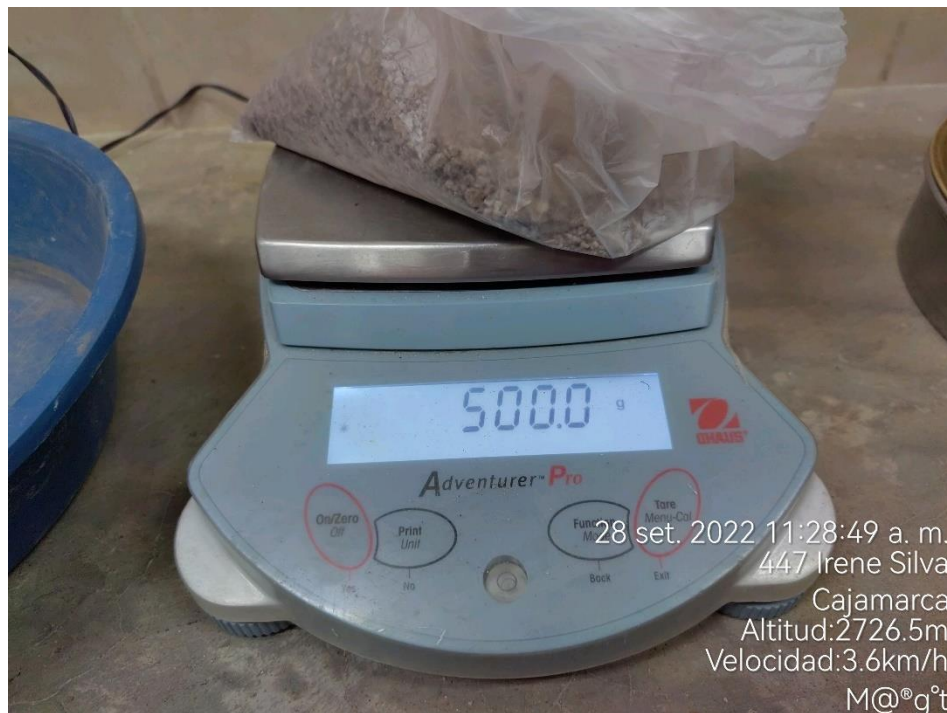
Fotografía N°07: Peso de muestra para ensayo de Granulometria por lavado.
