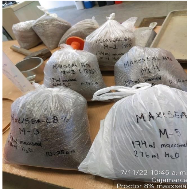
Fotografía N° 15: Muestras preparadas para ser compactadas en el ensayo de Proctor Modificado.
