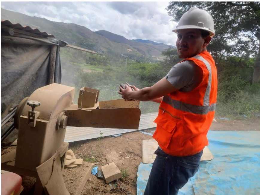
Figura 34: Trituración de la piedra caliza en el molino para arcilla.
