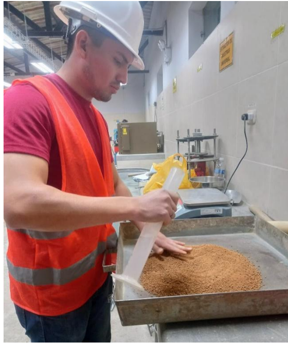
Figura 38: Humectando uniformemente el material con el porcentaje de agua correspondiente.
