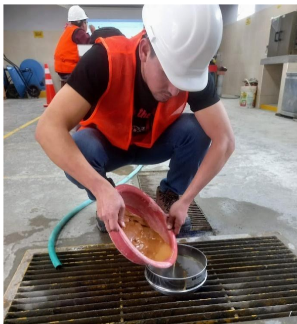
Figura 21: Se tamizó por la malla N° 200 mediante chorro de agua.
