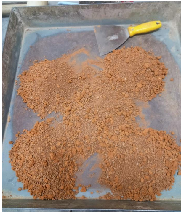
Figura 40: Cuarqueo de la muestra humedecida para el proctor modificado.
