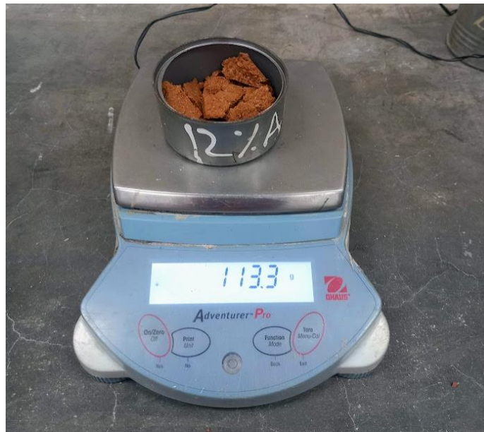
Figura 45: Pesado de muestra obtenida después de la colocación al horno durante 24 horas.
