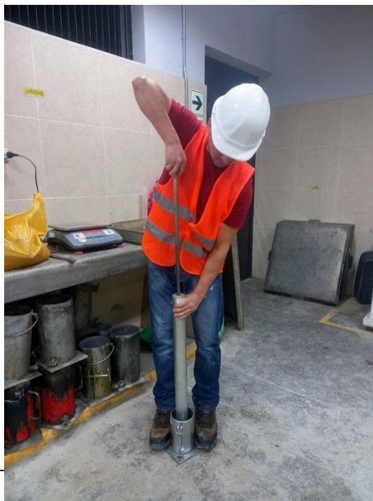
Figura 41: Compactación de capas con el pisón escogido.
