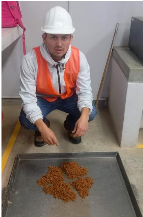
Figura 16: Cuarteo de material húmedo.
