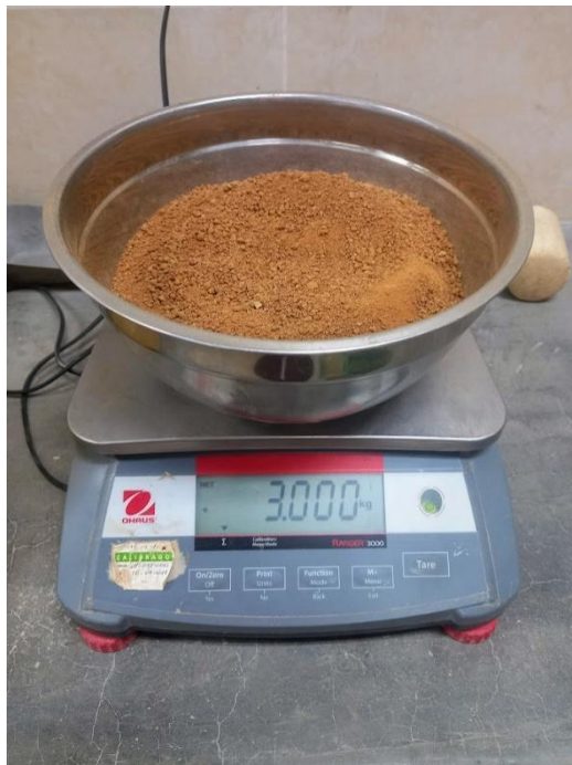
Figura 37: Pesado de material seco para proctor modificado.
