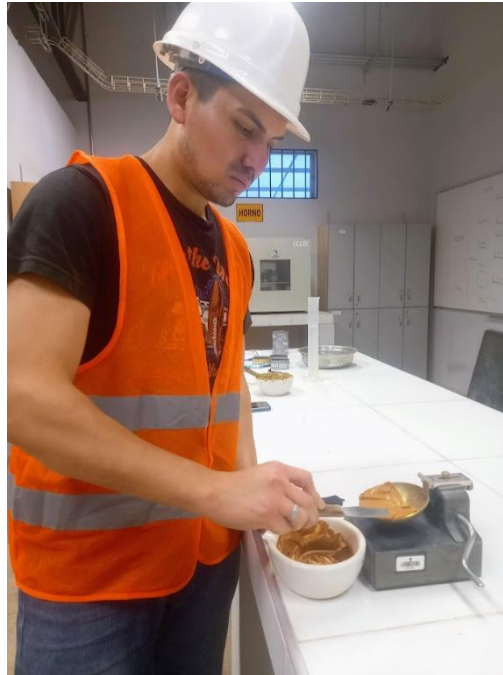
Figura 27: Preparación de la pasta para el ensayo de límite líquido en la copa de
