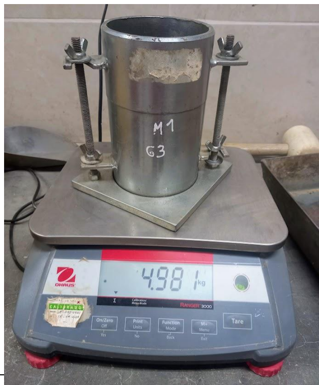
Figura 36: Pesado de molde cilíndrico para proctor modificado tipo A.
