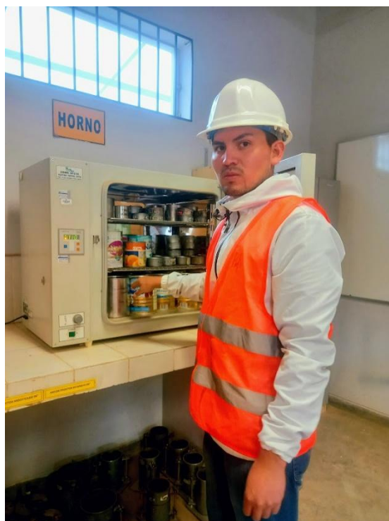
Figura 19: Colocación de muestras en el horno durante 24 horas.
