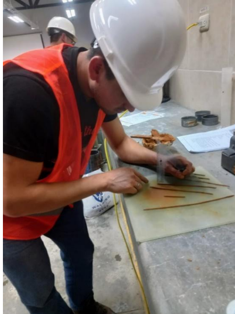
Figura 29: Enrollado de la muestra en 3 mm en la placa de vidrio para el ensayo de límite plástico.
