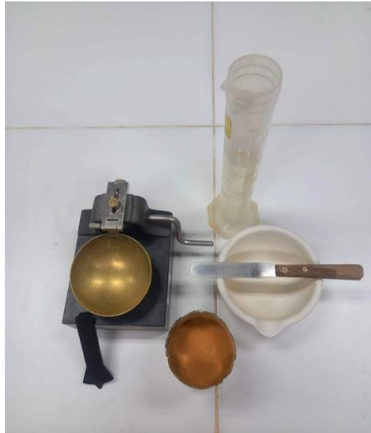
Figura 26: Equipo y material para realizar el ensayo de límite líquido.
