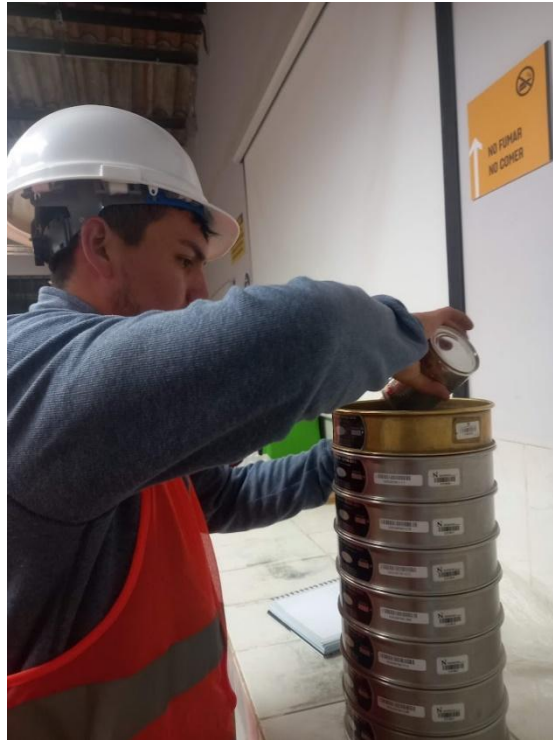
Figura 24: Se pasó el material lavado por el juego de tamices.
