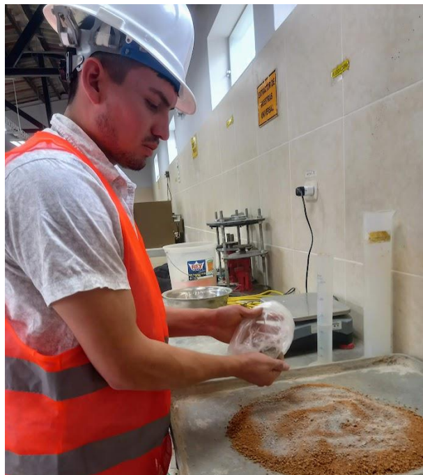
Figura 39: Adicionamiento de la piedra caliza triturada y tamizada por la malla N°4.
