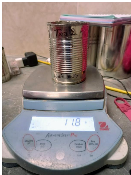
Figura 30: Pesado de muestra de límite plástico.
