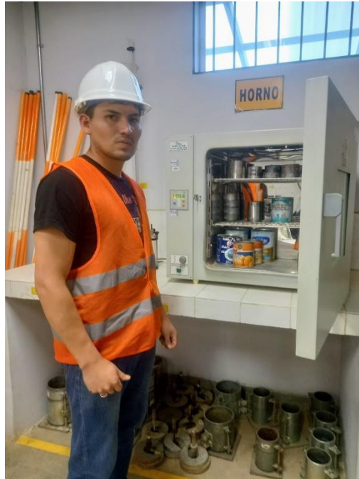
Figura 22: Secado de material en el horno por 24 horas.
