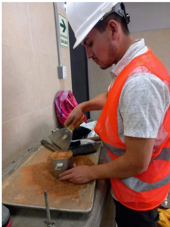
Figura 44: Extracción de la muestra humedad y compactada para contenido de humedad.
