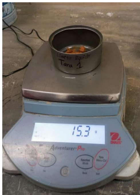
Figura 28: Pesado de la muestra para colocar en el horno durante 24 horas.
