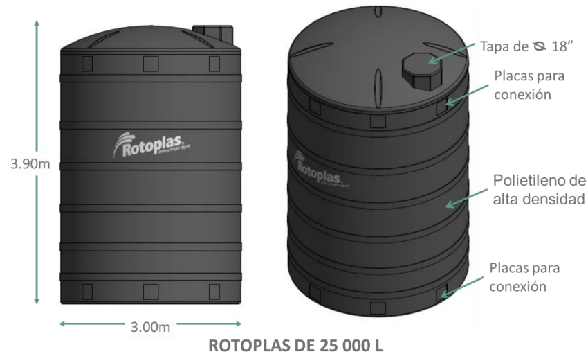
Figura 324. Tanque elevado - Rotoplas de 25 000 L
