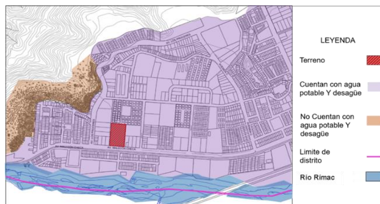
Figura 114. Nivel de abastecimiento de agua potable y desagüe
