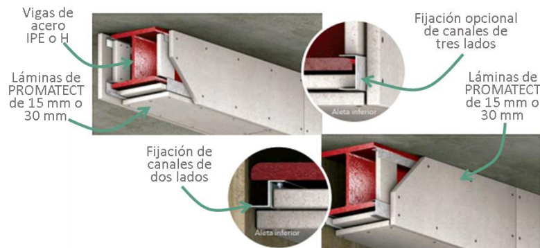
Figura 314. Revestimiento de vigas de acero
