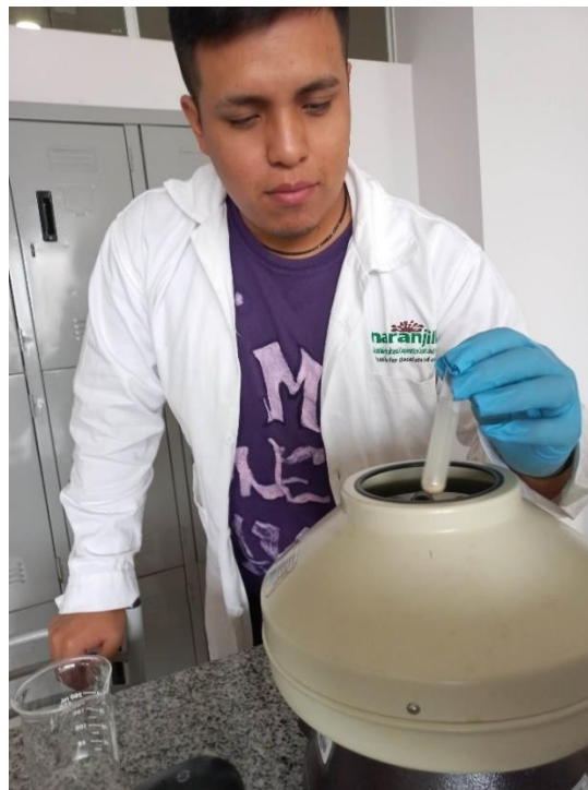
Figura 17 Centrifugado para la separación de la biomasa
