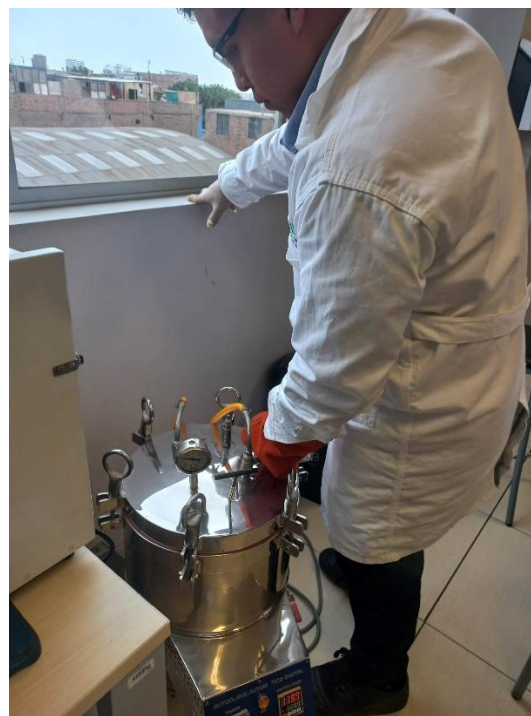
Figura 5 Autoclavado de materiales y medio de cultivo
