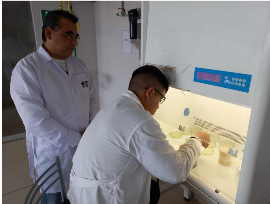
Figura 10 Aplicando la técnica de estriado de la biomasa en el medio de cultivo
