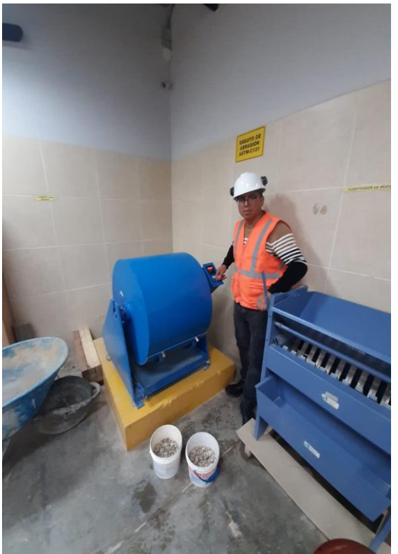
Foto N° 12: Ensayo de Abrasión de los ángeles MTC E 207.
