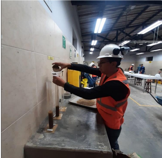
Foto N.º 17: Ensayo de Equivalente de Arena. MTC E 114
