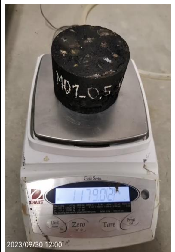
Foto N° 96: Peso de la briqueta al agua por 60'. MTC E504 – ASTM D6926
