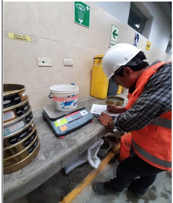
Foto N°6: Toma de datos de granulometría de los agregados MTC E 204.
