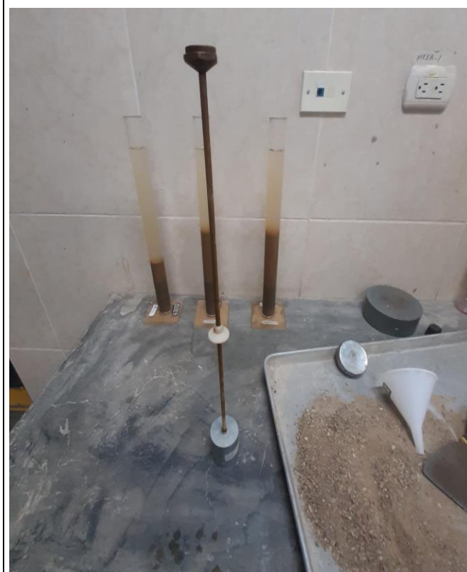
Foto N.º 17: Ensayo de Equivalente de Arena. MTC E 114
