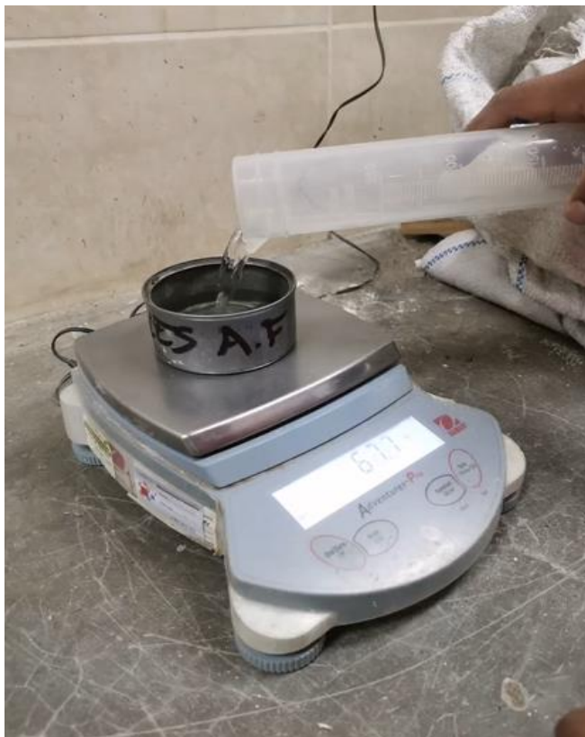
Foto N° 43: Peso de la solución para Proceso de filtración para sales solubles del agregado fino. MTC E219 / NTP 339.152
