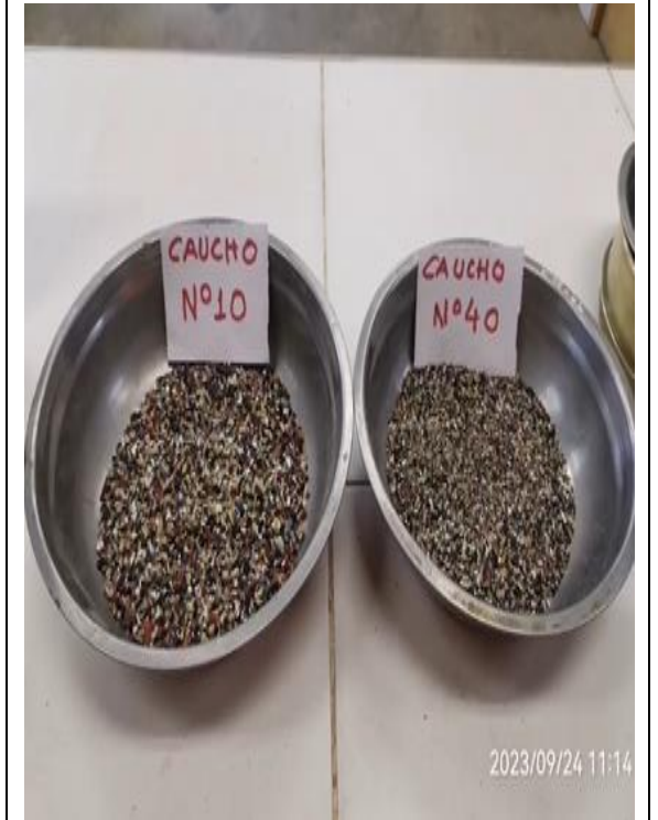
Foto N° 80: Caucho retenido en el tamiz N° 10 y N° 40 a ser reemplazado en el agregado fino. MTC E504 – ASTM D6926
