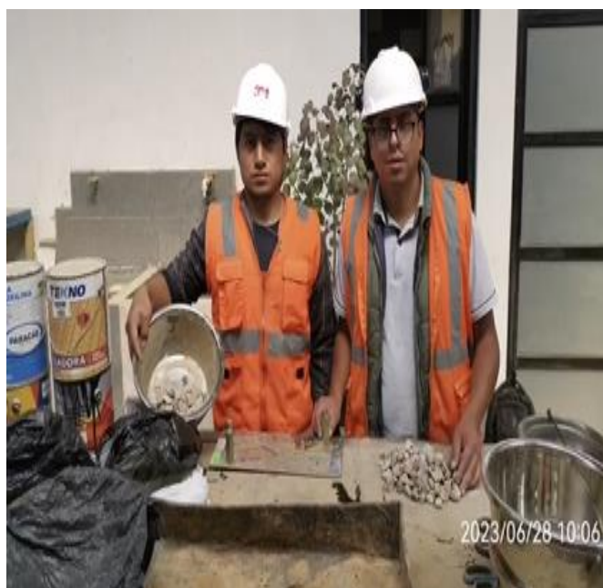
Foto N° 27: Preparación de muestra para Ensayo de Partículas chatas y alargadas del agregado grueso. MTC E 223 ASTM D5821
