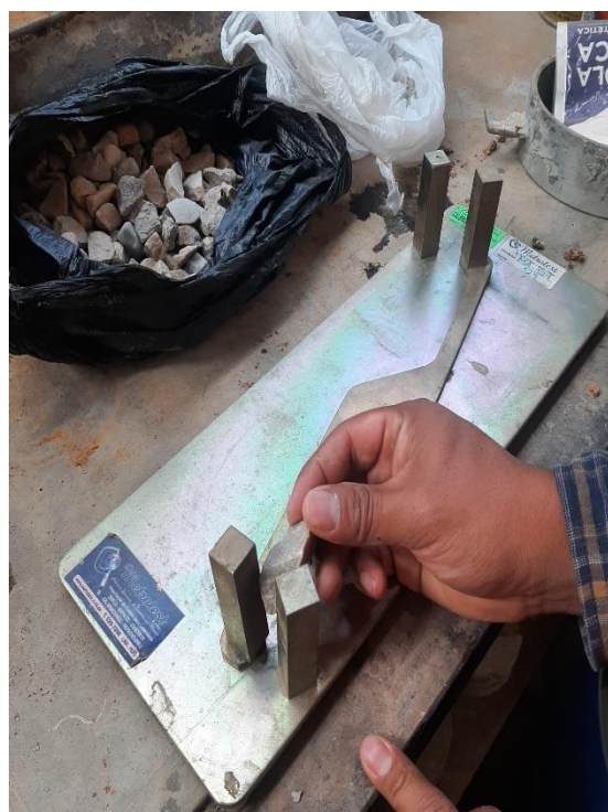
Foto N° 30: Determinación de partículas alargadas del agregado grueso. MTC E 223 ASTM D5821
