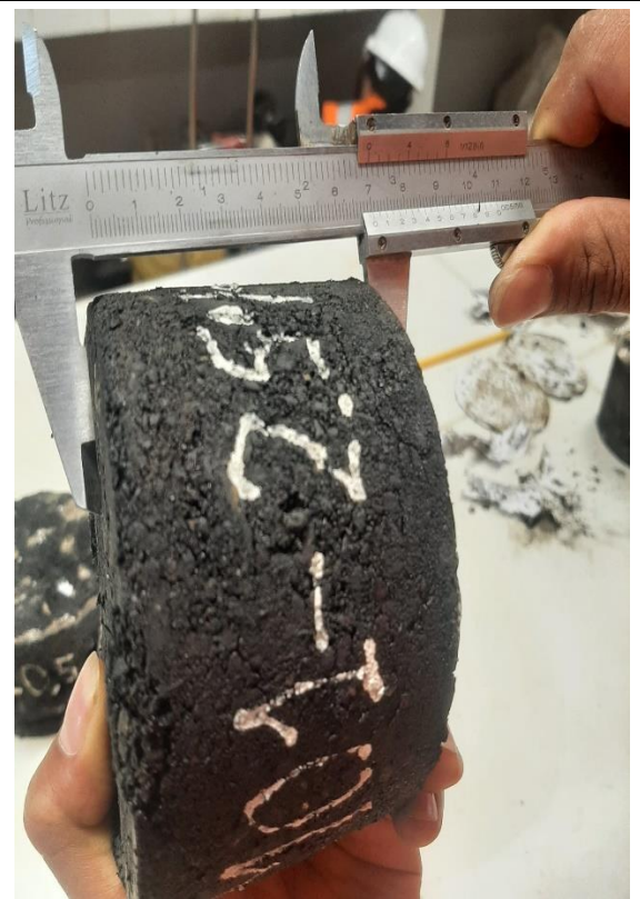
Foto N° 90: toma de la altura promedio de la briqueta con 2.5% de caucho. MTC E504 – ASTM D6926
