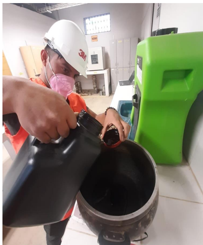
Foto N° 56: colocación del cemento asfáltico para la elaboración de briquetas. MTC E504 – ASTM D6926
