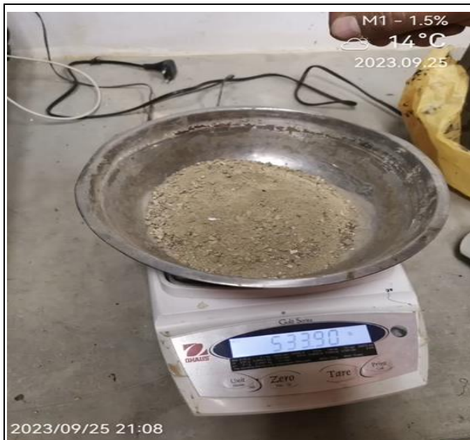
Foto N° 83: Combinación del agregado fino, con el porcentaje de 1.5% de caucho.
