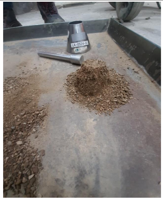
Foto N° 10: Gravedad específica y absorción de los agregados finos. MTC E 205
