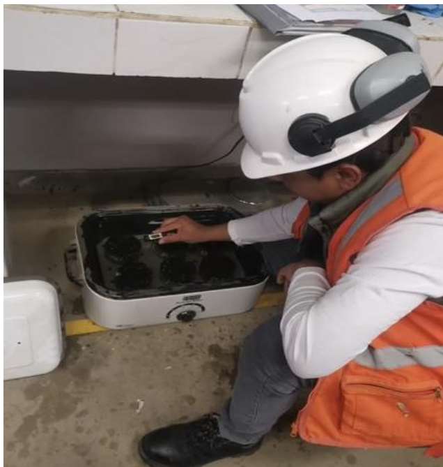
Foto N° 99: Baño maría de las briquetas con caucho, control de temperatura. MTC E504 – ASTM D6926
