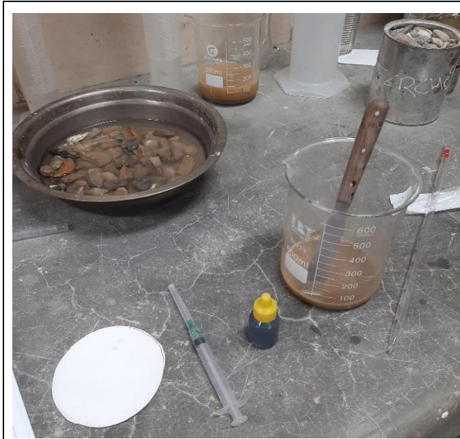
Foto N° 33: Ensayo Azul de Metileno del ASSTHO TP 57 / INVE E 235-07.
