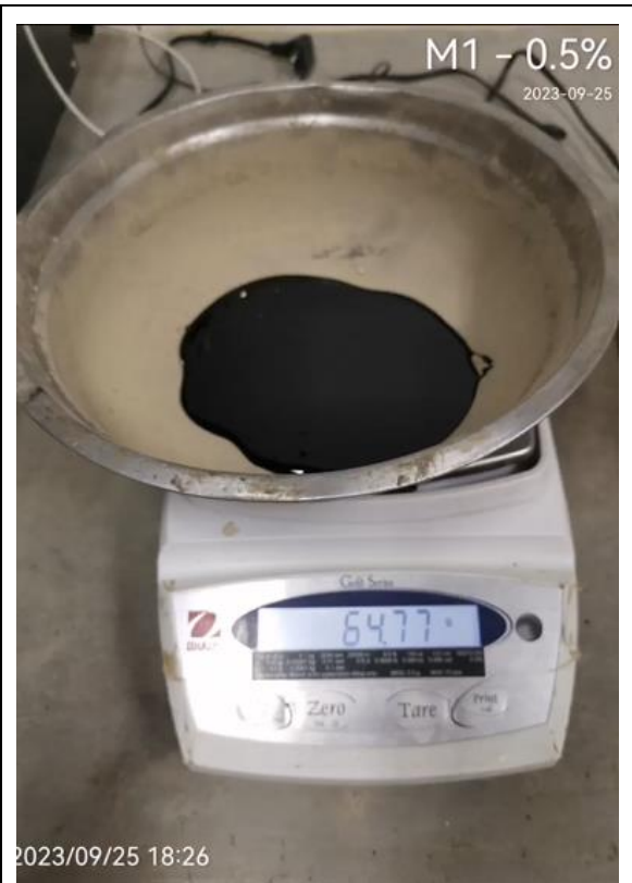
Foto N° 82: Peso del cemento asfáltico para el porcentaje de 0.5% de caucho. MTC E504 – ASTM D6926
