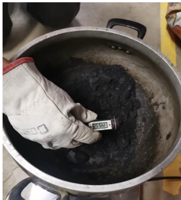
Foto N° 59: Control de temperatura de la mezcla asfáltica en caliente. MTC E504 – ASTM D6926
