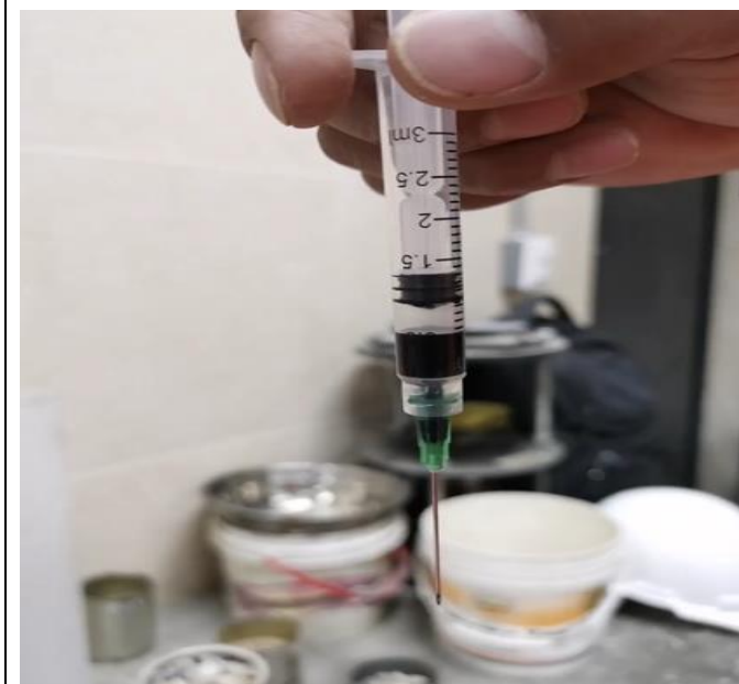
Foto N° 35: Ensayo Azul de Metileno del Agregado. ASSTHO TP 57/INVE E 235-07.
