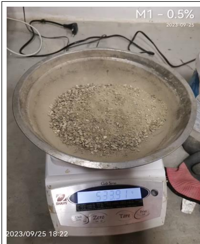
Foto N° 81: Combinación del caucho con el agregado fino, para el 0.5% de reemplazo. MTC E504 – ASTM D6926
