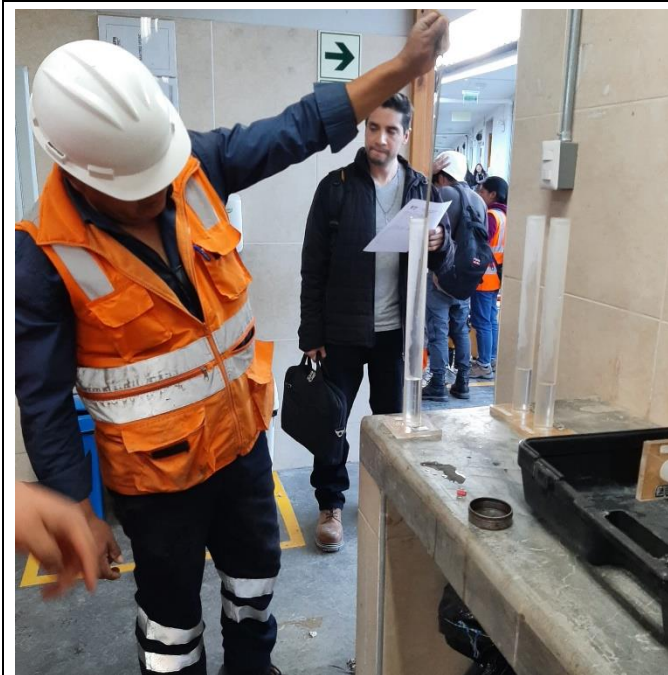
Foto N° 15: Ensayo de Equivalente de Arena, Incorporando solución de trabajo con asesoría del Coordinador de laboratorio. MTC E 114
