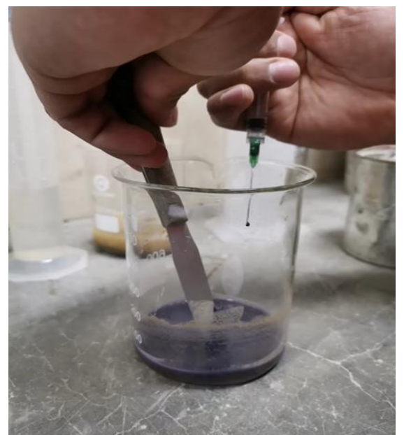
Foto N° 36: Incorporación de 0.5 ml de azul de metileno en el agregado.
