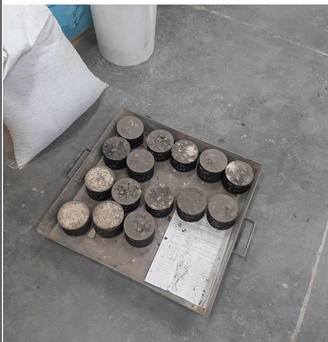
Foto N° 97: Briquetas sometidas a pruebas de resistencia a la deformación. MTC E504 – ASTM D6926
