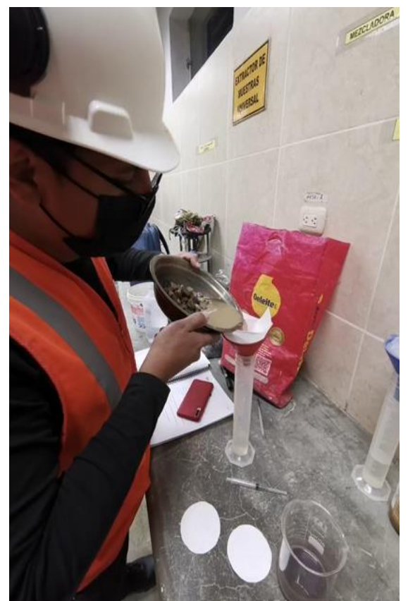
Foto N° 40: Proceso de filtración para sales solubles del agregado grueso.
