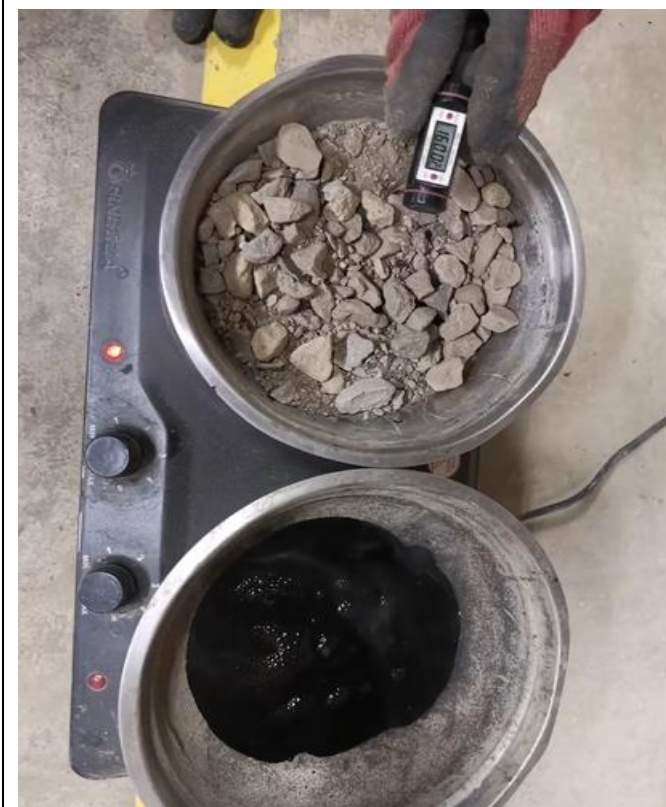
Foto N° 87: Calentamiento de los agregados y cemento asfáltico para los porcentajes de caucho respectivos. MTC E504 – ASTM D6926
