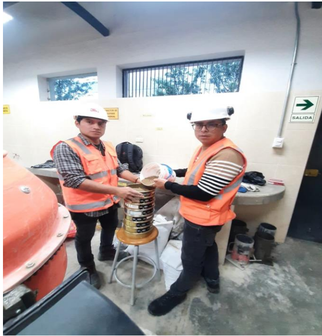
Foto N° 5: Análisis granulométrico de agregado fino MTC E 204.
