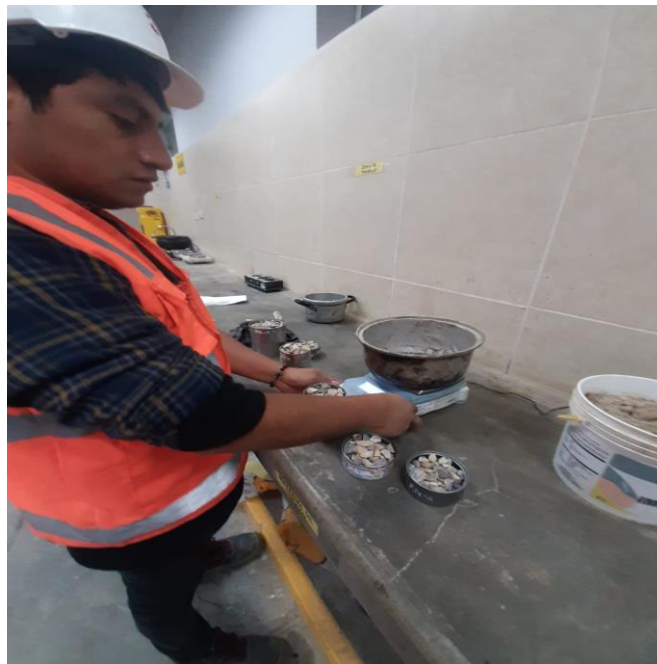
Foto N° 7: Pesos del análisis granulométrico de agregado grueso MTC E 204.
