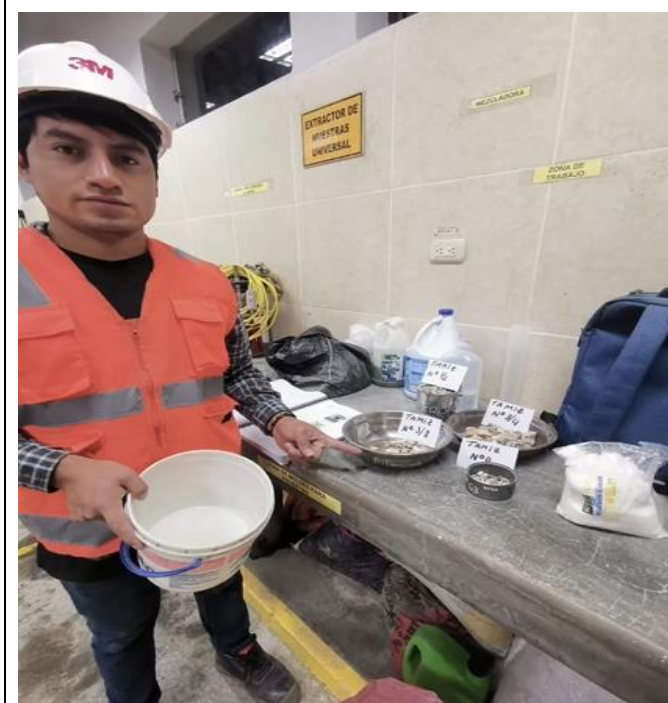
Foto N° 47: Ensayo de Sulfato de Magnesio del agregado grueso. MTC E209
