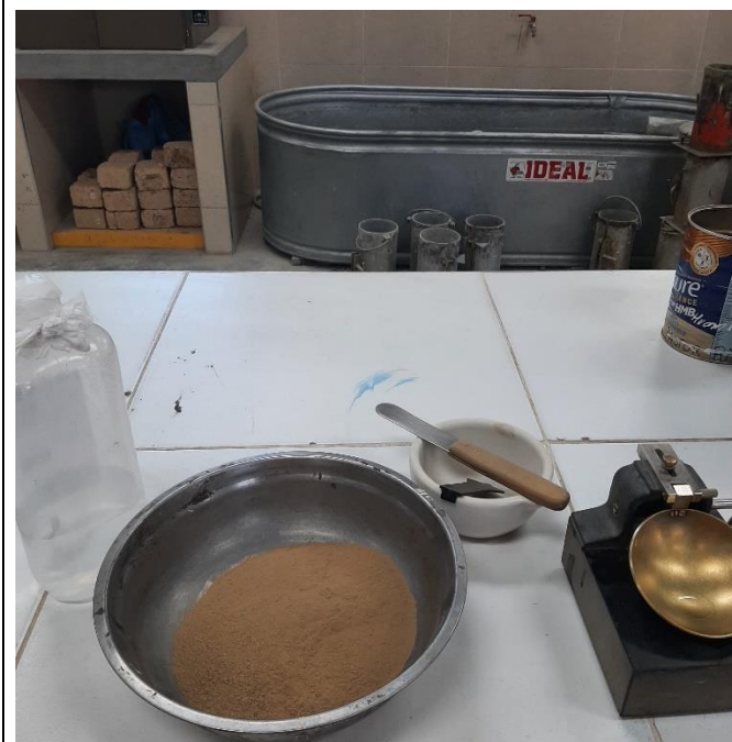
Foto N.º 23: Muestra lista para límites de consistencia. MTC E 111.
