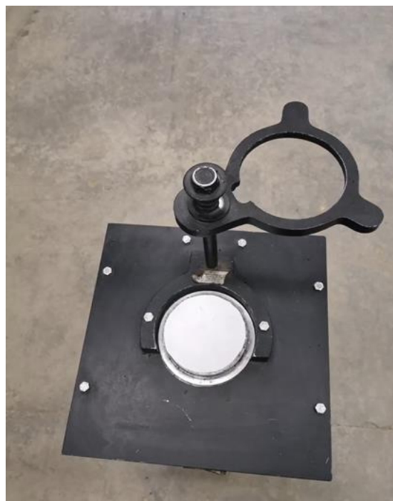
Foto N° 60: Equipo para la elaboración de las briquetas – Ensayo Marshall. MTC E504 – ASTM D6926
