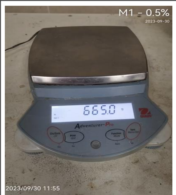
Foto N° 94: Peso desplazado de la briqueta para los diferentes porcentajes de caucho. MTC E504
