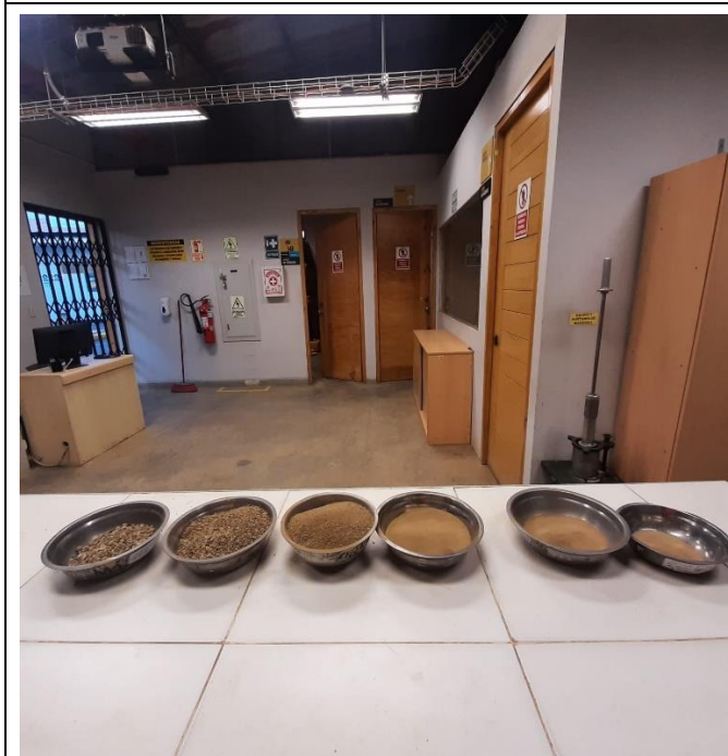
Foto N° 53: Tamizado de los agregados para el MAC-01. MTC E504 – ASTM D692.
