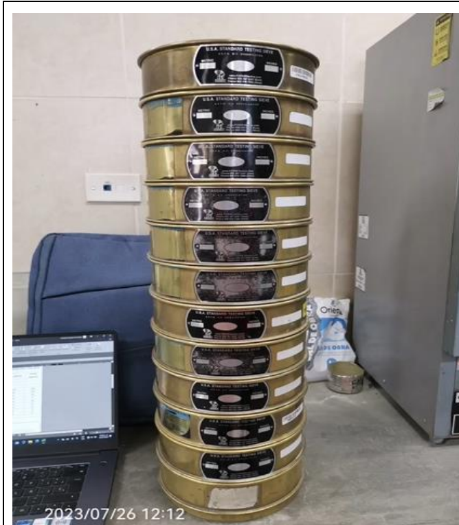
Foto N° 53: Tamizado de los agregados para el MAC-01. MTC E504 – ASTM D692.
