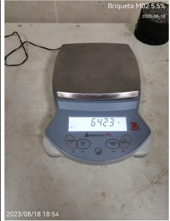
Foto N° 66: Peso de la briqueta desplazada. MTC E504 – ASTM D6926
