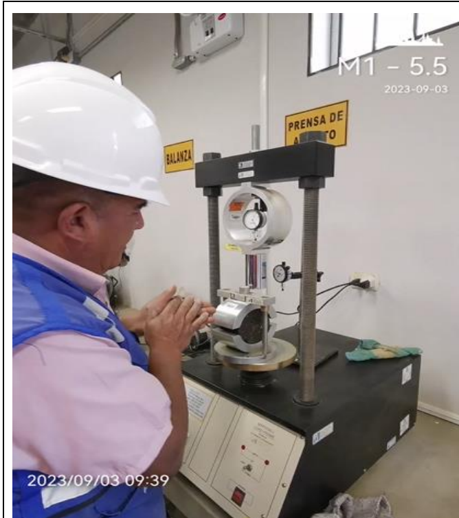
Foto N° 69: Determinación de la Resistencia a la Deformación (Estabilidad) de la briqueta.
