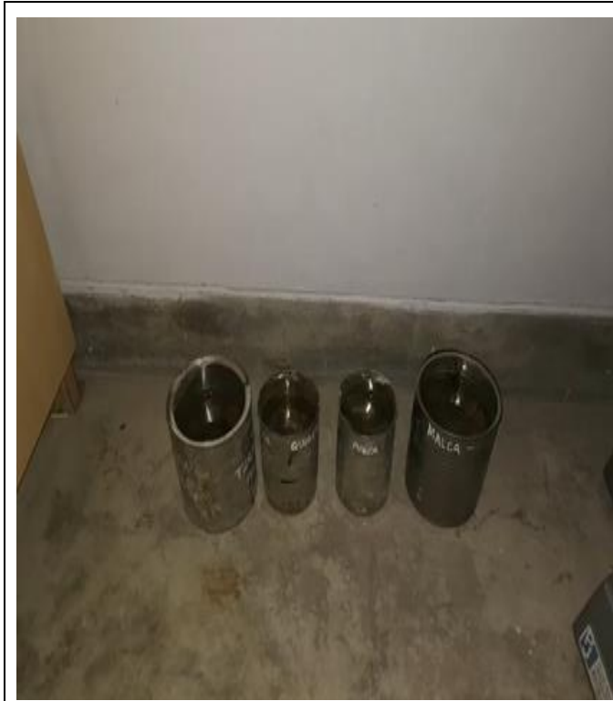
Foto N° 49: Muestras de agregado grueso sumergido en sulfato de magnesio. MTC E209
