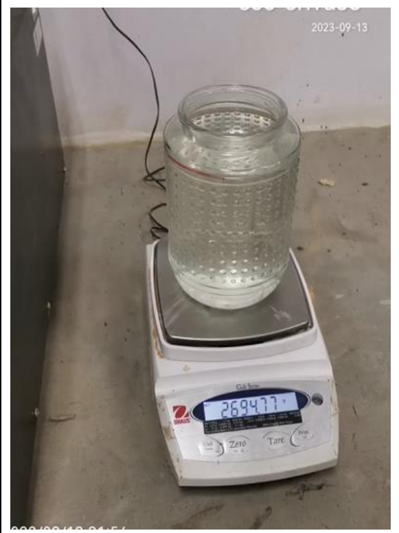
Foto N° 72: Peso del envase más agua para el ensayo RICE. MTC E 508/ASTM D 2041
