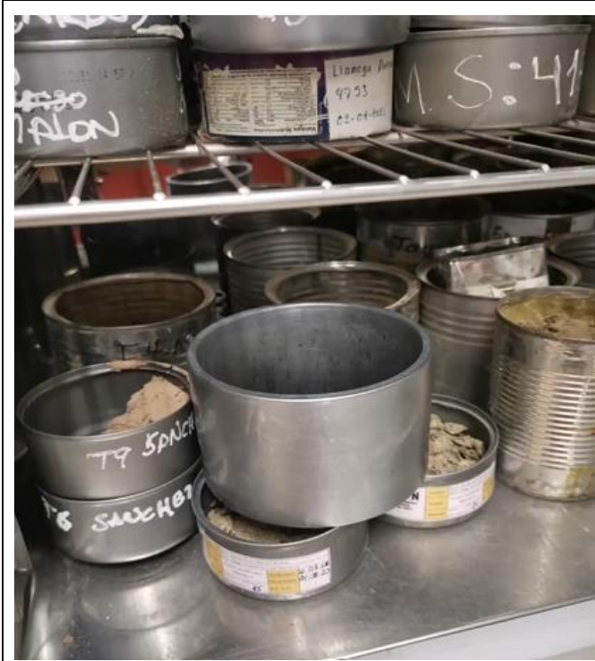
Foto N° 61: Calentamiento de los moldes para la elaboración de las briquetas. MTC E504 – ASTM D6926.
