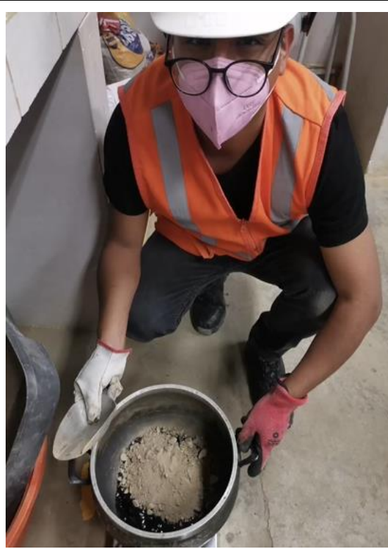
Foto N° 58: Combinación de los agregados con el cemento asfáltico. MTC E504 – ASTM D6926
