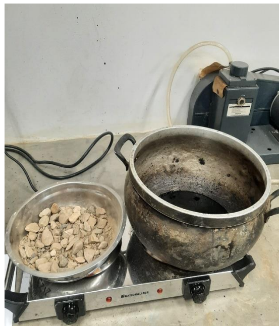
Foto N° 56: Calentamiento del cemento asfáltico y agregados para la elaboración de briquetas. MTC E504 – ASTM D6926
