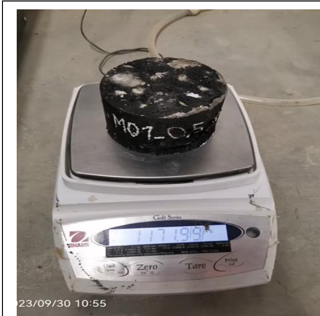
Foto N° 93: Peso al aire de la briqueta para los diferentes porcentajes de caucho. MTC E504 – ASTM D6926
