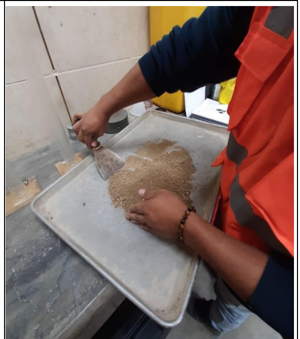
Foto N.º 16: Ensayo de Equivalente de Arena, Preparación de muestra. MTC E 114
