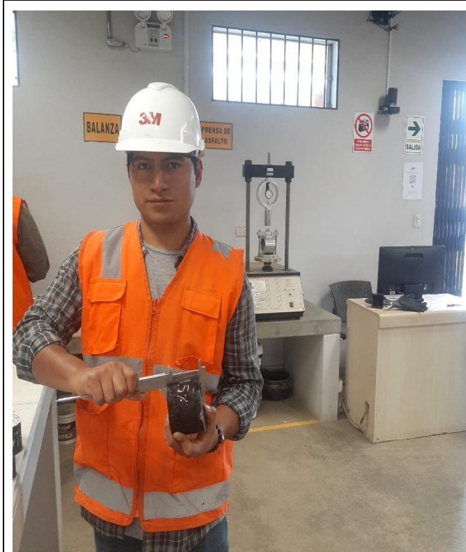
Foto N° 89: Toma de la altura promedio de la briqueta con 2.5% de caucho. MTC E504 – ASTM D6926
