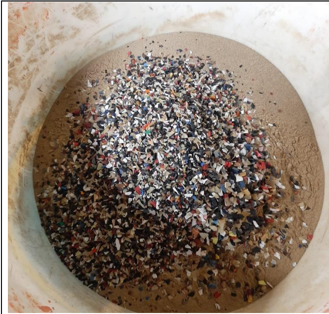
Foto N° 85: Combinación del caucho con el agregado fino, para el 2.5% de reemplazo. MTC E504 – ASTM D6926
