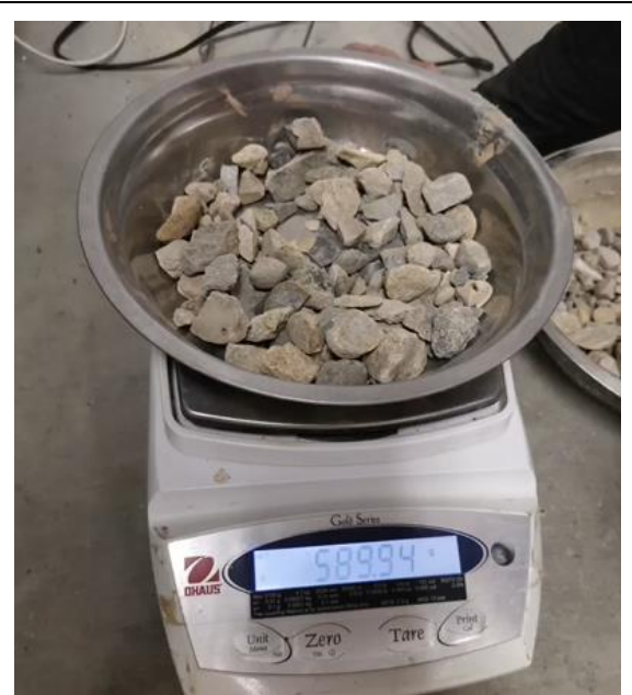
Foto N° 86: Peso del agregado grueso para el 2.5% de caucho. MTC E504 – ASTM D6926
