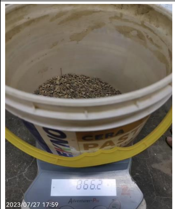
Foto N° 54: Pesado de los agregados para la elaboración de briquetas. MTC E504 – ASTM D6926
