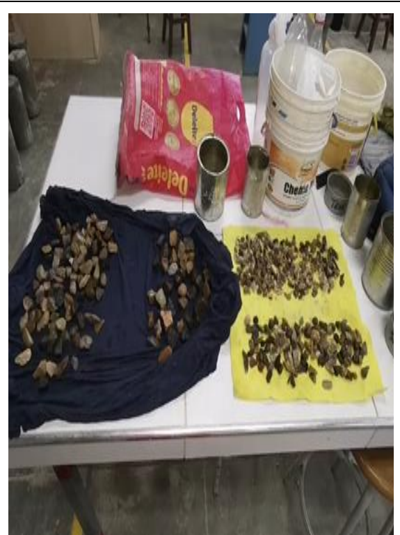
Foto N° 50: Ensayo de caras fracturadas del agregado grueso. MTC E 210, ASTM D-5821
