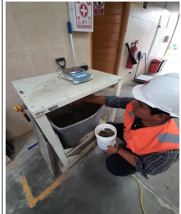
Foto N° 8: Peso específico y absorción de los agregados gruesos. MTC E 206
