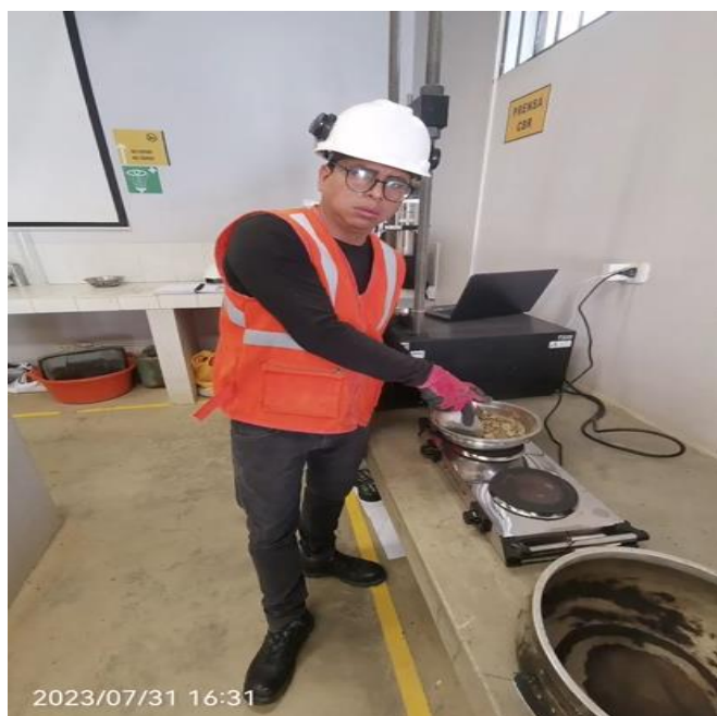
Foto N° 55: Calentamiento de los agregados para la elaboración de briquetas. MTC E504 – ASTM D6926
