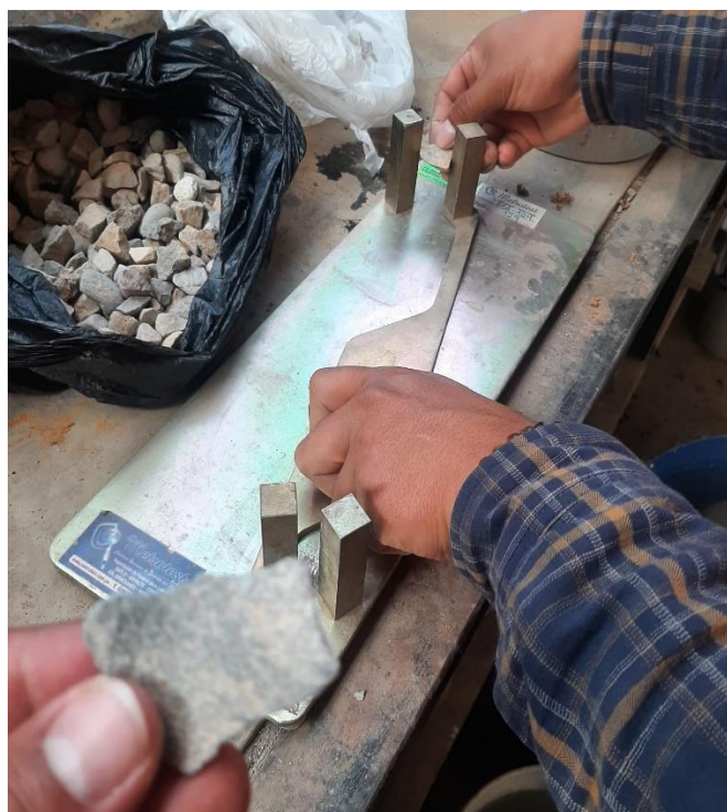
Foto N° 29: Ensayo de Partículas chatas del agregado grueso. MTC E 223 ASTM D5821
