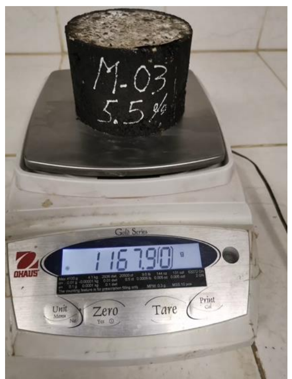
Foto N° 64: Peso de la briqueta al aire. MTC E504 – ASTM D6926
