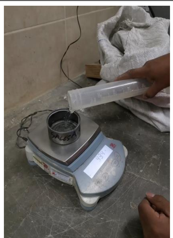
Foto N° 46: Peso de sales solubles en agua destilado del agregado grueso. MTC E219 / NTP 339.152
