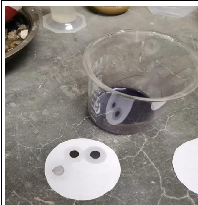
Foto N° 37: Coloración en el papel filtro del agregado fino con el azul de metileno.
