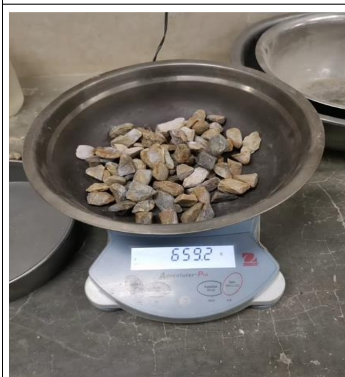
Foto N° 51: Determinación del peso de las partículas de 1/2" para caras fracturadas. MTC E 210, ASTM D-5821
