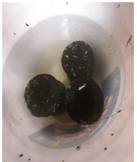
Foto N° 92: Curado de las briquetas por 20 minutos en envase con agua.
