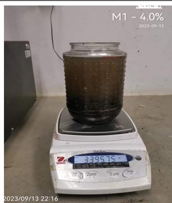
Foto N° 76: Peso de la mezcla asfáltica en agua para la determinación del valor RICE. MTC E 508/ASTM D 2041
