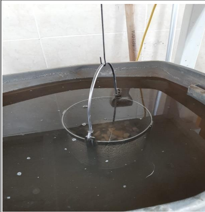
Foto N° 9: Peso específico y absorción de los agregados gruesos, peso sumergido. MTC E 206
