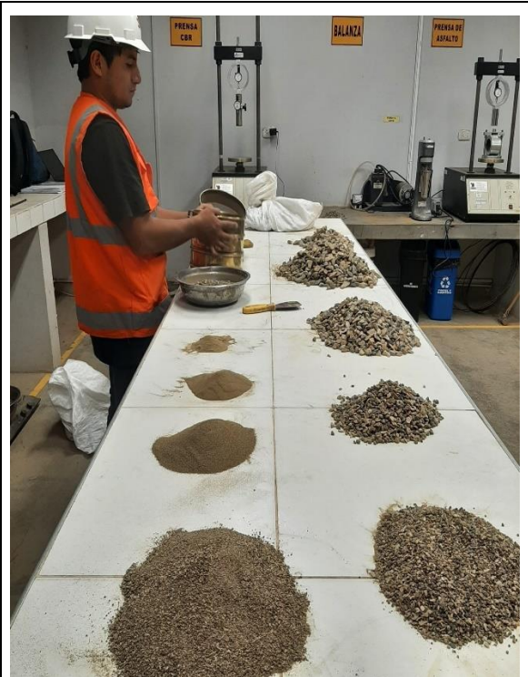
Foto N° 54: Pesado de los agregados para la elaboración de briquetas. MTC E504 – ASTM D6926
