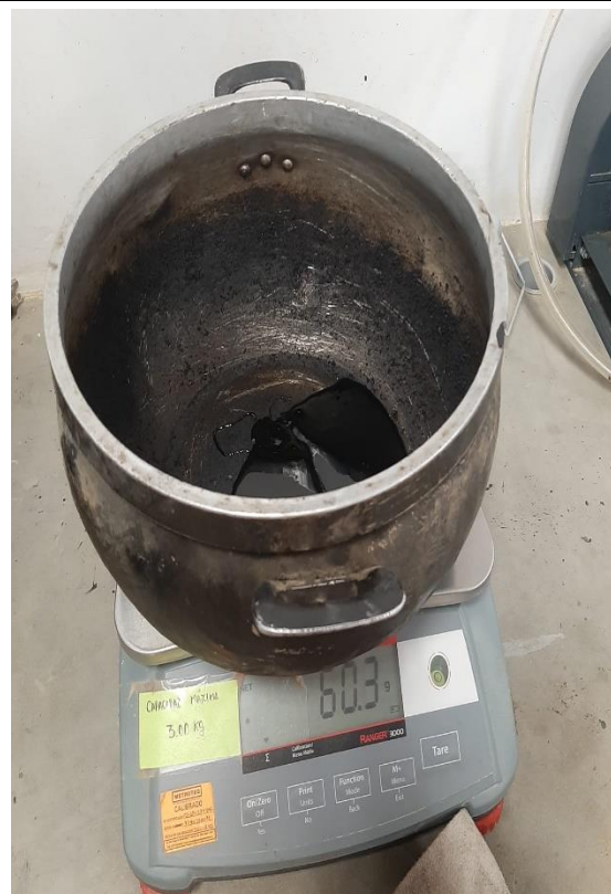
Foto N° 54: Peso de cemento asfáltico. MTC E504 – ASTM D6926
