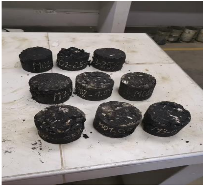
Foto N° 101: Muestra de las briquetas con reemplazo de caucho al 0.5%, 1.5% y 2.5% luego de la rotura por la máquina de Marshall. MTC E504 – ASTM D6926.
