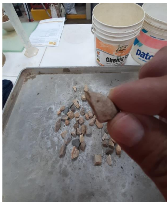
Foto N° 32: Ensayo de Partículas fracturadas del agregado grueso MTC E 223 ASTM D5821
