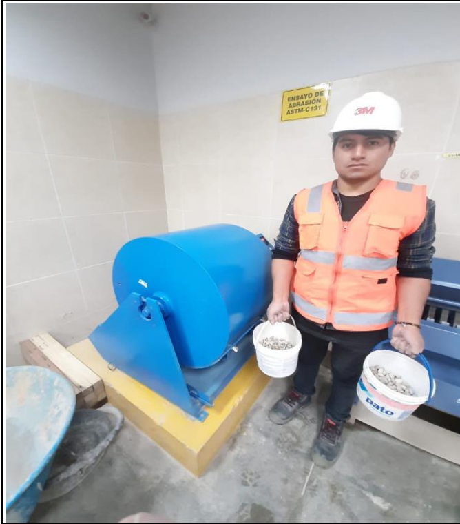
Foto N° 13: Verificando la calidad de material de la cantera "Bazán" en el equipo de los ángeles MTC E 207.
