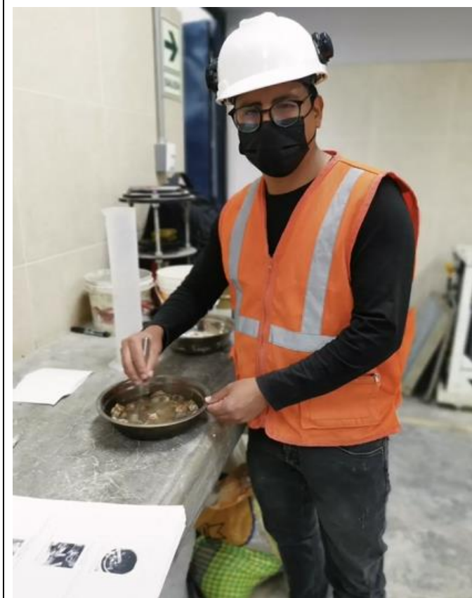
Foto N° 39: Ensayo de Sales Solubles del Agregado Grueso. MTC E219 / NTP 339.152
