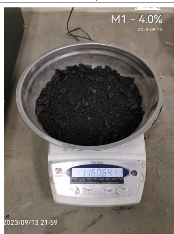
Foto N° 74: Peso de la mezcla asfáltica para el ensayo RICE. MTC E 508/ASTM D 2041
