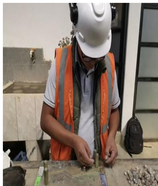
Foto N° 28: Equipo adecuado para ensayo de Partículas chatas y alargadas del agregado grueso. MTC E 223 ASTM D5821
