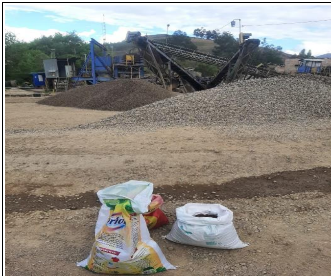
Foto N° 1: Cantera "Bazán contratistas S.R.L." Obtención de agregado fino y grueso para ensayos de control de calidad.
