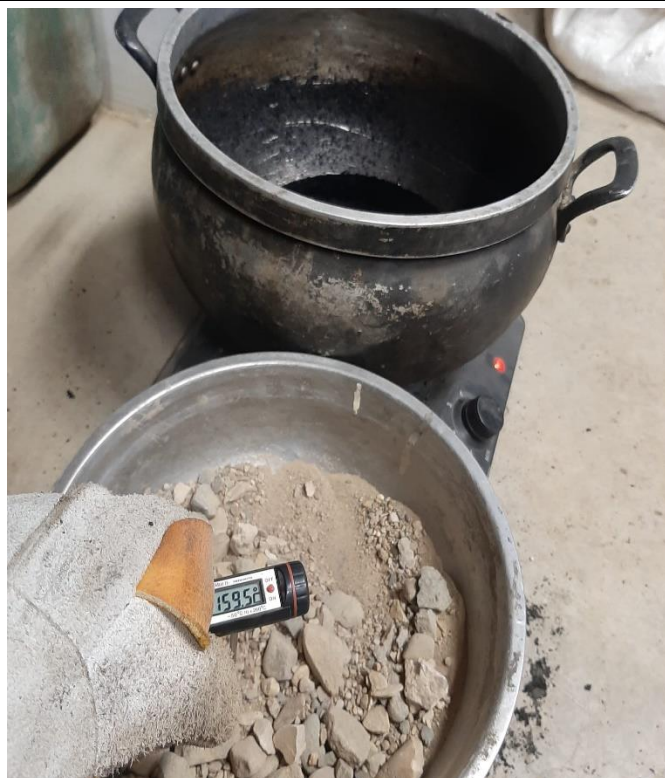
Foto N° 57: Control de temperatura de los agregados. MTC E504 – ASTM D6926
