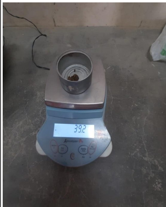
Foto N° 26: Peso para límites de Consistencia en la malla N° 200. MTC E 111
