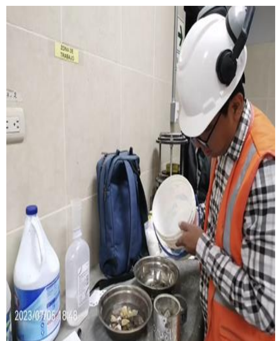
Foto N° 48: Incorporación de la sustancia de magnesio en el agregado. MTC E209
