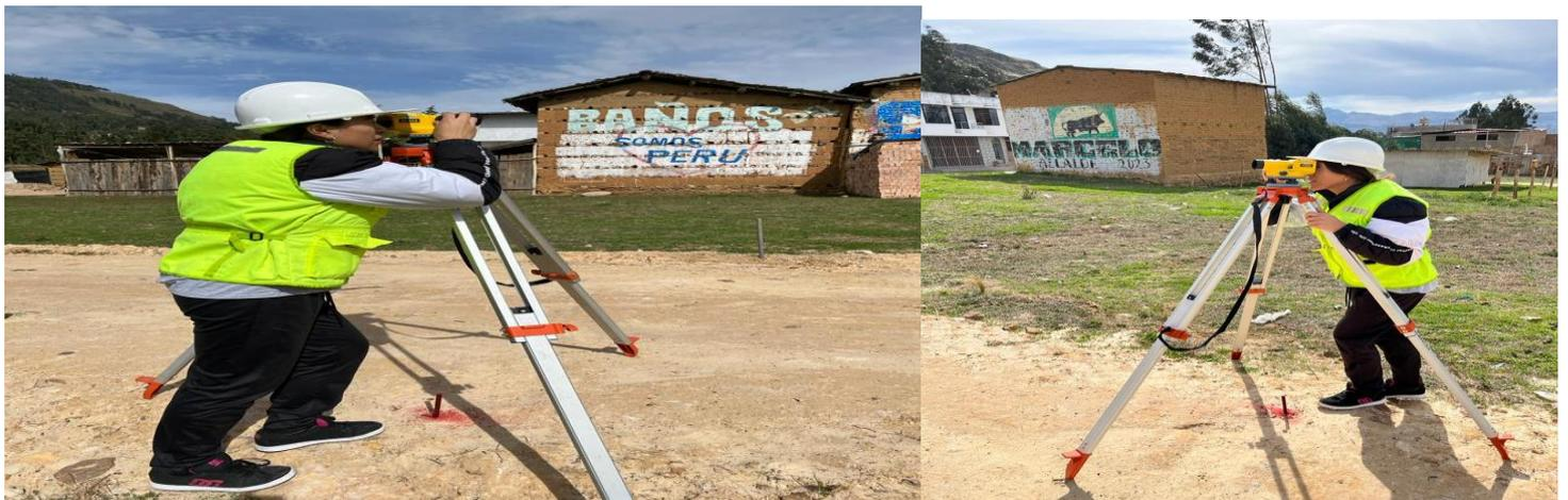
*Ilustración 7 Instrumental para la Recopilación de datos de asentamiento*
