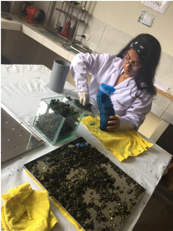
Ilustración 29: Rellenado de filtros
