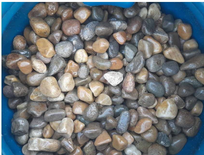
Fotografía N° 10: Ubicación de la piedra para el filtro de carbón activado
