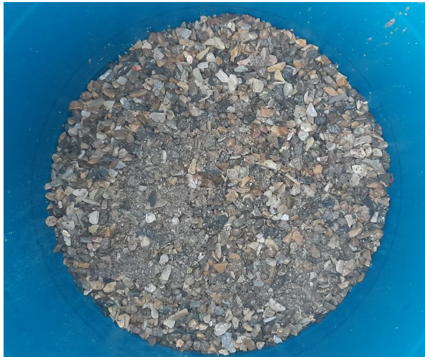
Fotografía N° 12: Ubicación de la gravilla para el filtro de zeolita
