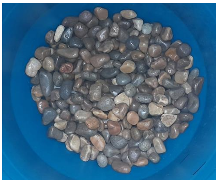
Fotografía N° 15: Ubicación de la piedra para el filtro de arena
