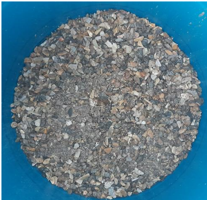
Fotografía N° 16: Ubicación de la gravilla para el filtro de arena
