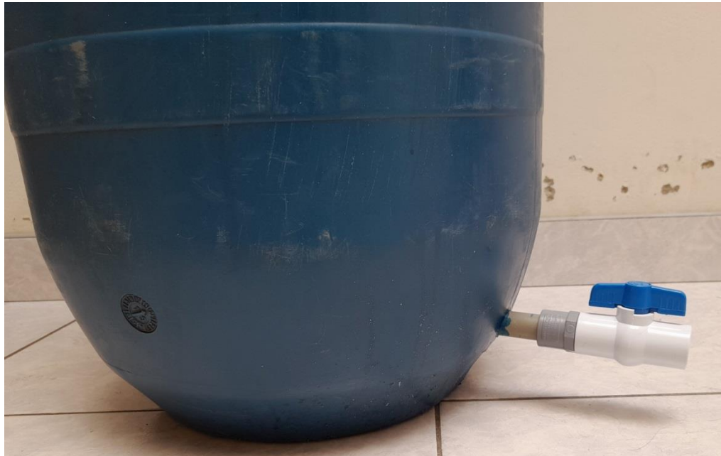
Fotografía N° 3: Salida agua de los filtros para la recolección de las muestras
