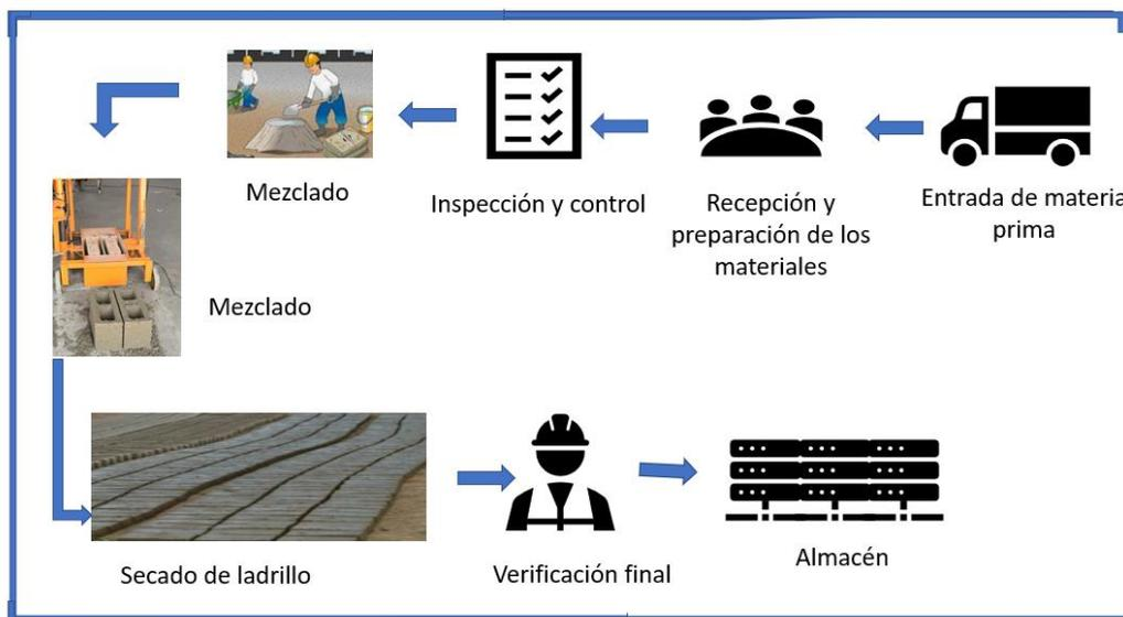
En el diagrama de procesos y operaciones se puede visualizar un tiempo total de producción de un lote, en un tiempo promedio de 97.47 min para la culminación de un lote respectivo de 125 ladrillos. Se procedió al cálculo de la siguiente manera tomando en cuenta los siguientes datos:
