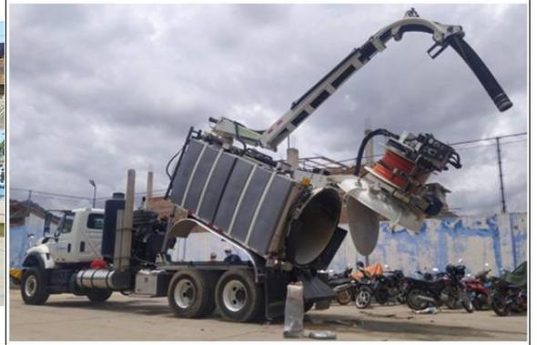
Observaciones: Hidrojet parqueada incorrectamente, tanque levantado, compuerta abierta y manguera de succión elevada.
