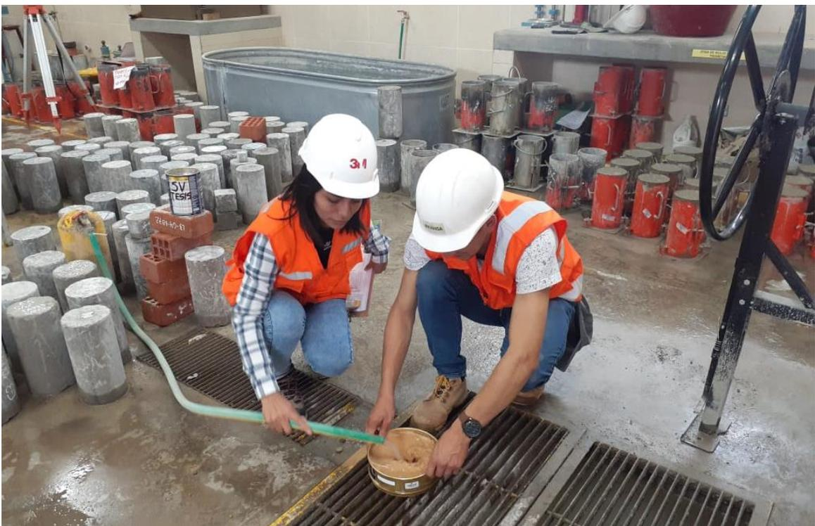
*Nota.* Realización del ensayo de análisis granulométrico mediante tamizado por lavado.
