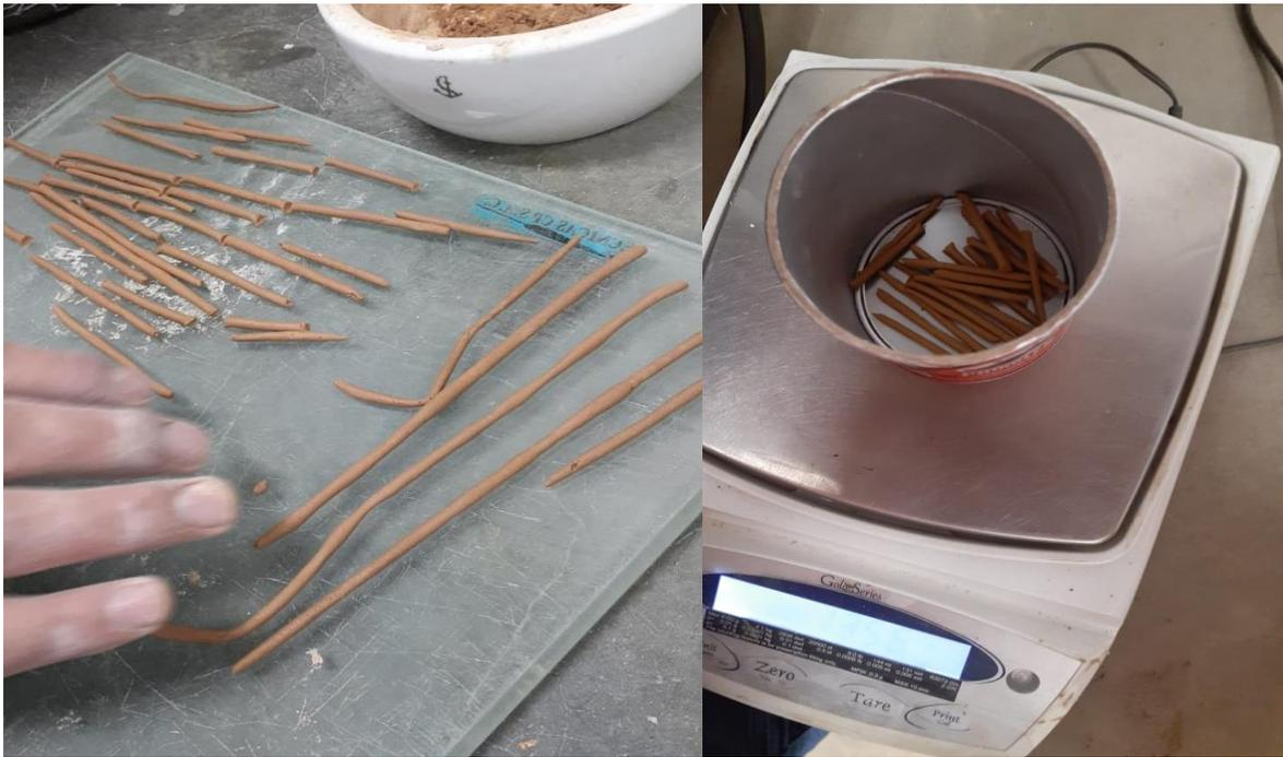
*Nota.* Realización de cilindros para el ensayo de Límite Plástico.
