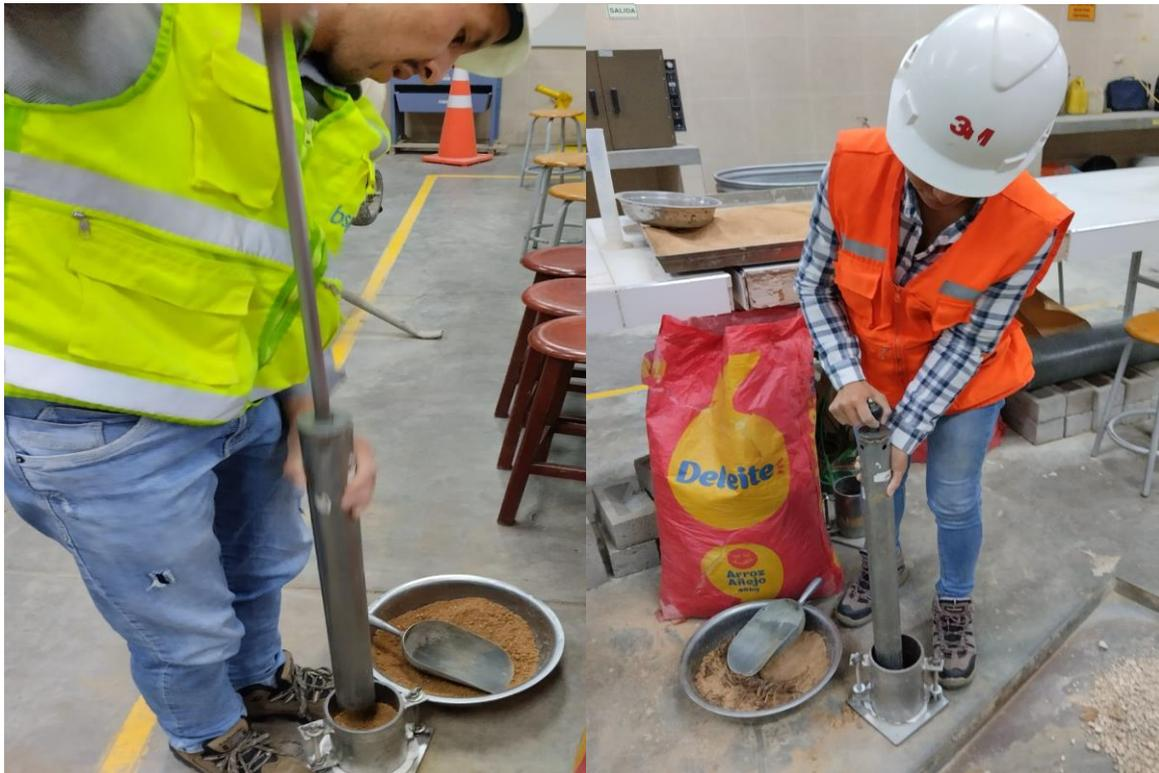
*Nota.* Realización del ensayo de compactación de proctor modificado, haciendo uso del martillo de compactación.
