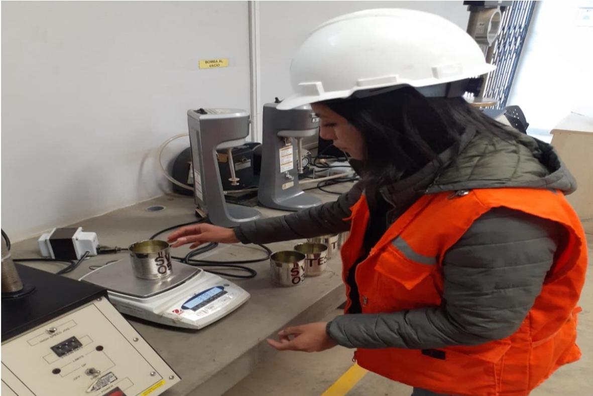
*Nota.* Pesado de muestras para ensayo de contenido de humedad.
