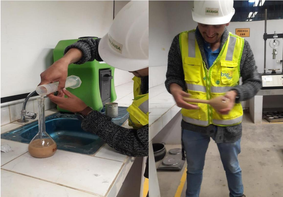
*Nota.* Realización del ensayo de peso específico relativo de sólidos.
