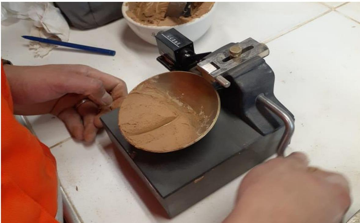
*Nota.* Muestra en la Copa de Casagrande para el ensayo de Límite Líquido.
