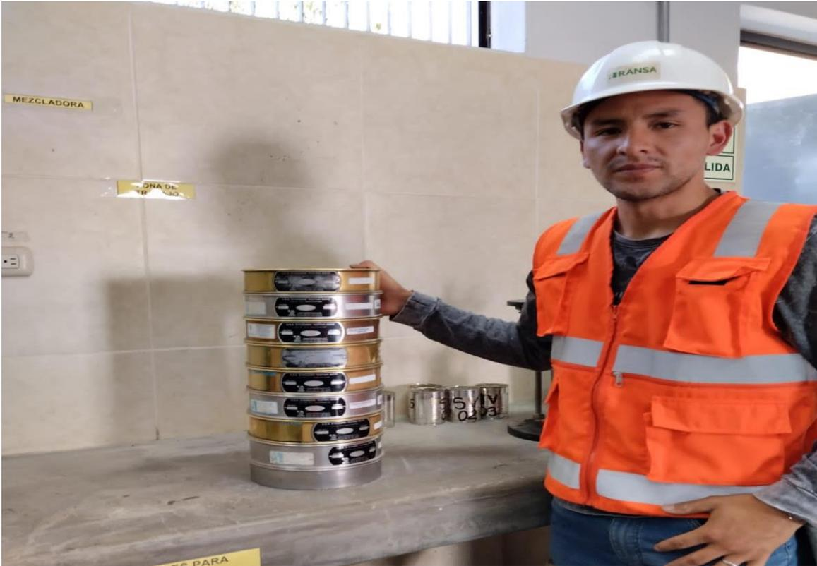
*Nota.* Juego de tamices para el ensayo de granulometría.
