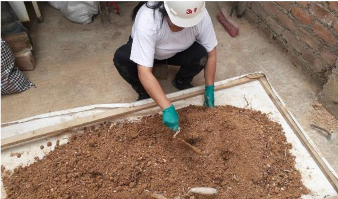
*Nota.* Mezclado de fibra y suelo seco hasta tener una mezcla homogénea.
