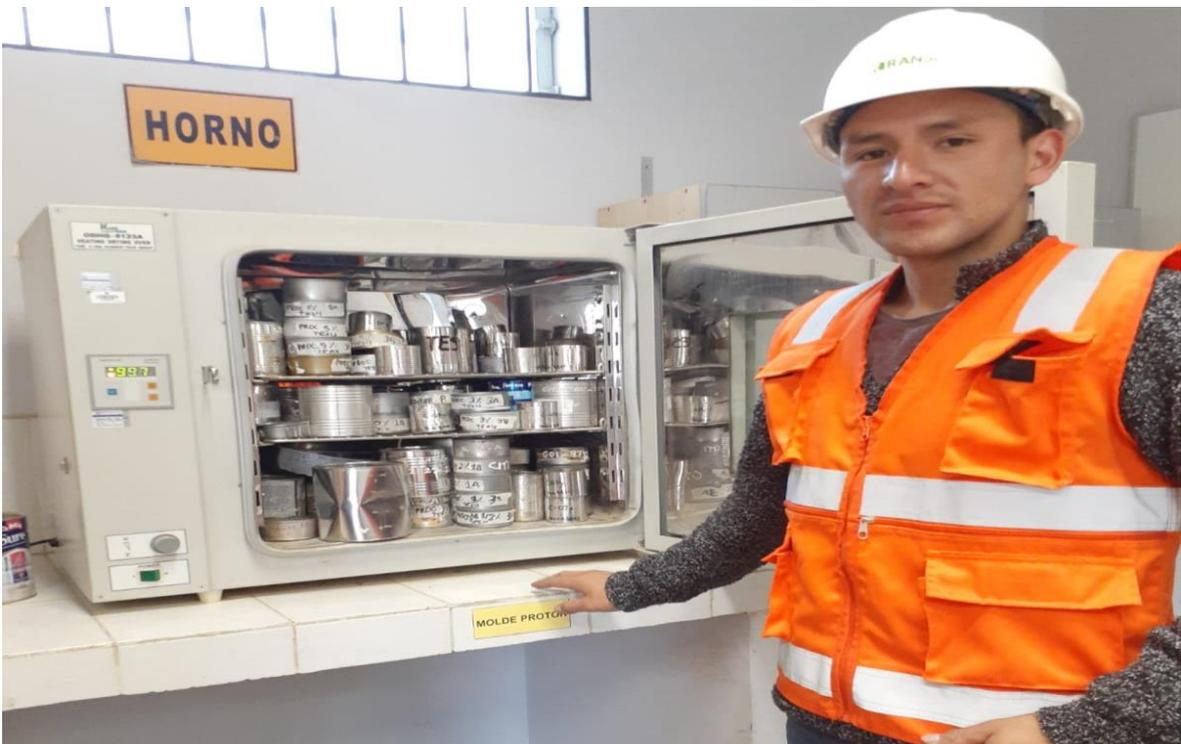
*Nota.* Colocación de muestras en horno para el ensayo de contenido de humedad.
