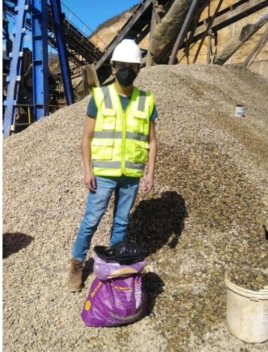
Nota. se almacenó en una bolsa plástica para evitar pérdida de humedad y evitar alteraciones antes de los ensayos
