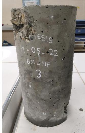
Nota. La fractura de la Probeta Patrón 6% - 02 fue de Tipo 5
