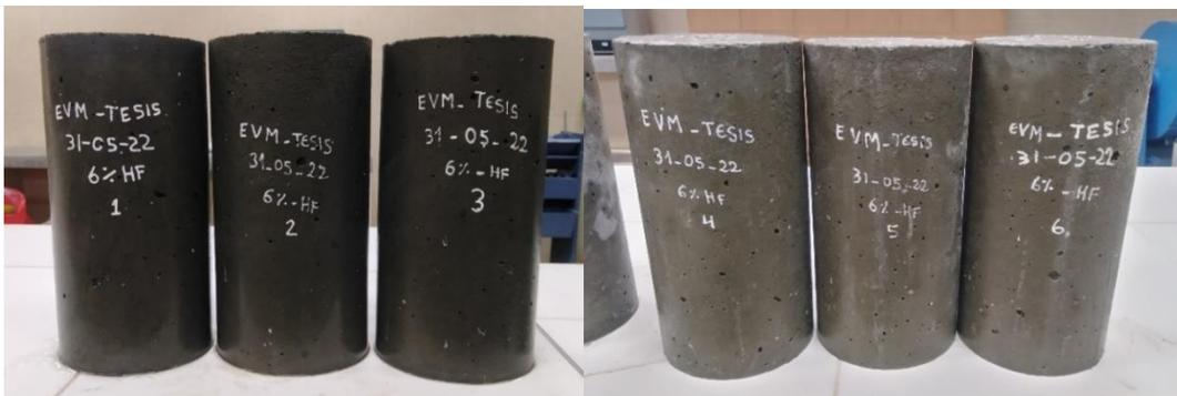
Se realizo el ensayo de resistencia a la compresión a los 7 días las probetas 1, 2 y 3 de 4% - HF y 6% - HF y a los 8 días las probetas 1, 2 y 3 patrones y de 2% - HF debido a problemas con los horarios.
