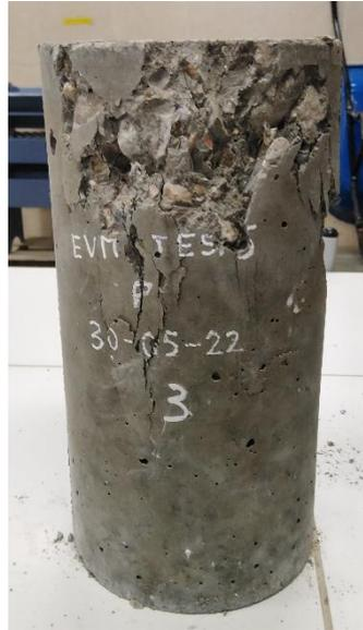
NOTA. La fractura de la Probeta Patrón P – 03 fue de Tipo 2
