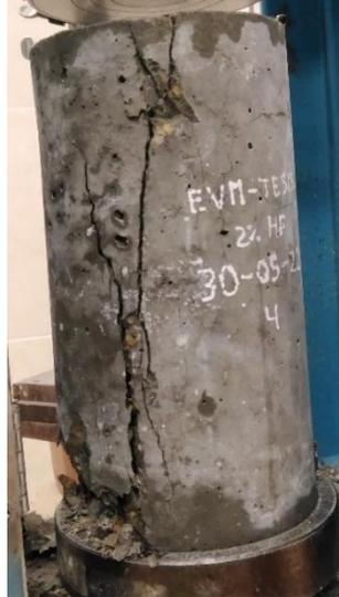
NOTA. La fractura de la Probeta Patrón 2% - 04 fue de Tipo 3
