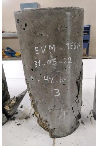
Nota. La fractura de la Probeta Patrón 4% - 03 fue de Tipo 6
