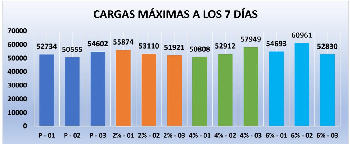
Nota. en el grafico se separó por colores cada diseño de mezcla y muestran las cargas máximas obtenidas en laboratorio
