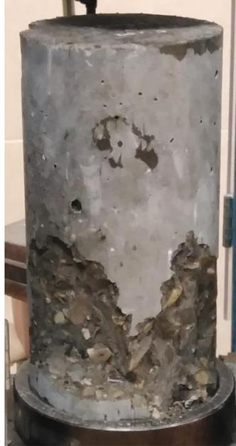
Nota. La fractura de la Probeta Patrón P - 05 fue de Tipo 5
