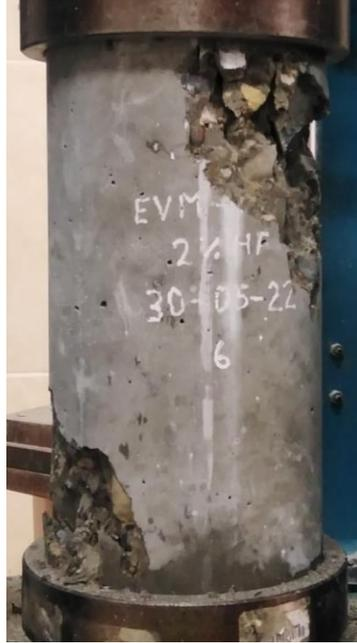
Nota. La fractura de la Probeta Patrón 2% - 06 fue de Tipo 5
