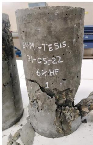
Nota. La fractura de la Probeta Patrón 6% - 01 fue de Tipo 2
