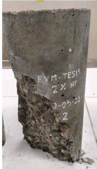
*Nota.* La fractura de la Probeta Patrón 2% - 02 fue de Tipo 4
