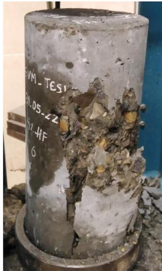
Nota. La fractura de la Probeta Patrón 4% - 06 fue de Tipo 2
