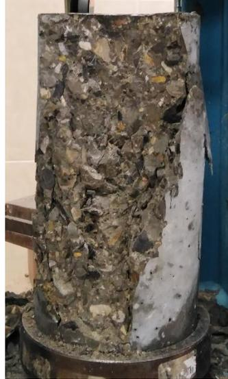
Nota. La fractura de la Probeta Patrón 6% - 04 fue de Tipo 3
