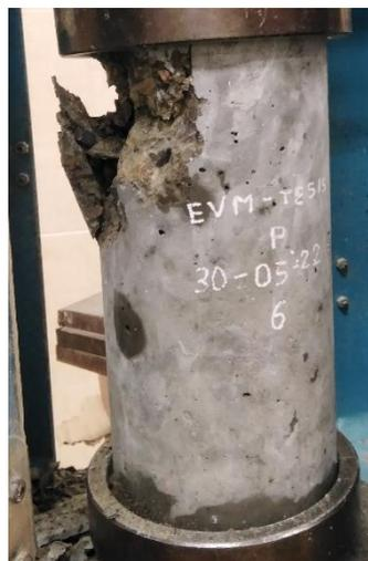
Nota. La fractura de la Probeta Patrón P - 06 fue de Tipo 5
