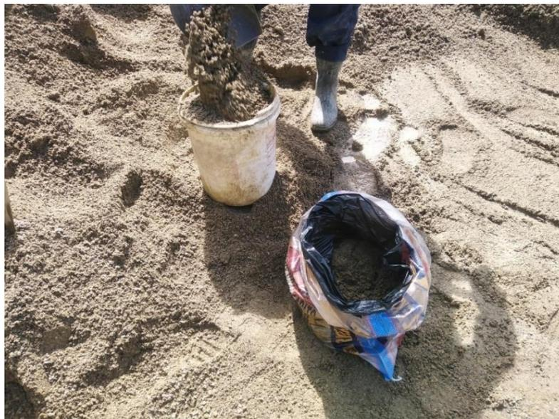
Nota. se almacenó en una bolsa plástica para evitar pérdida de humedad y evitar alteraciones antes de los ensayos
