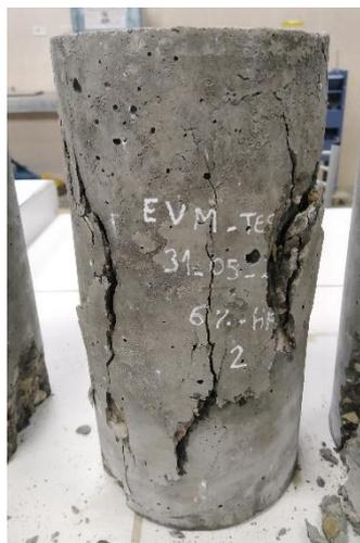
NOTA. La fractura de la Probeta Patrón 6% - 02 fue de Tipo 2
