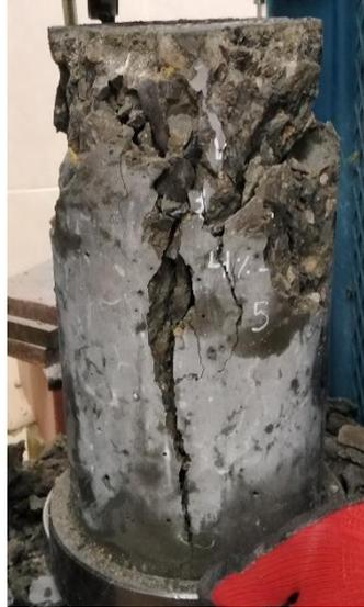
NOTA. La fractura de la Probeta Patrón 4% - 05 fue de Tipo 3
