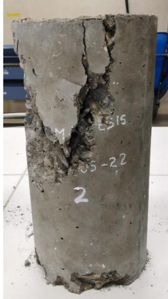
NOTA. La fractura de la Probeta Patrón P – 02 fue de Tipo 5
