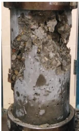
NOTA. La fractura de la Probeta Patrón 4% - 04 fue de Tipo 3
