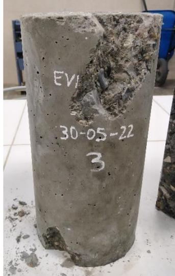
Nota. La fractura de la Probeta Patrón 2% - 03 fue de Tipo 5
