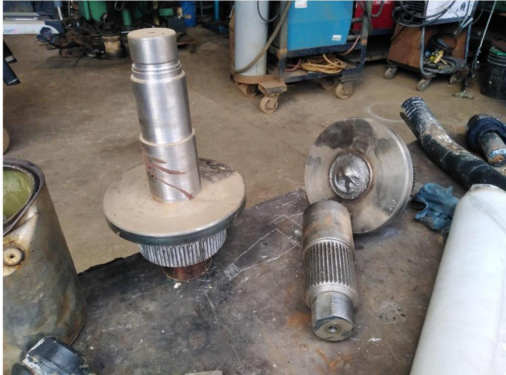
*Nota.* Pieza fabricada a la izquierda y pieza rota a la derecha
