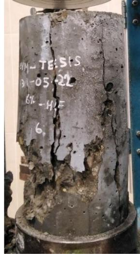
NOTA. La fractura de la Probeta Patrón 6% - 06 fue de Tipo 3
