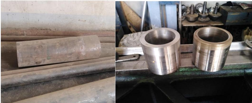
**Figura 107: Fabricación de pieza rota**
