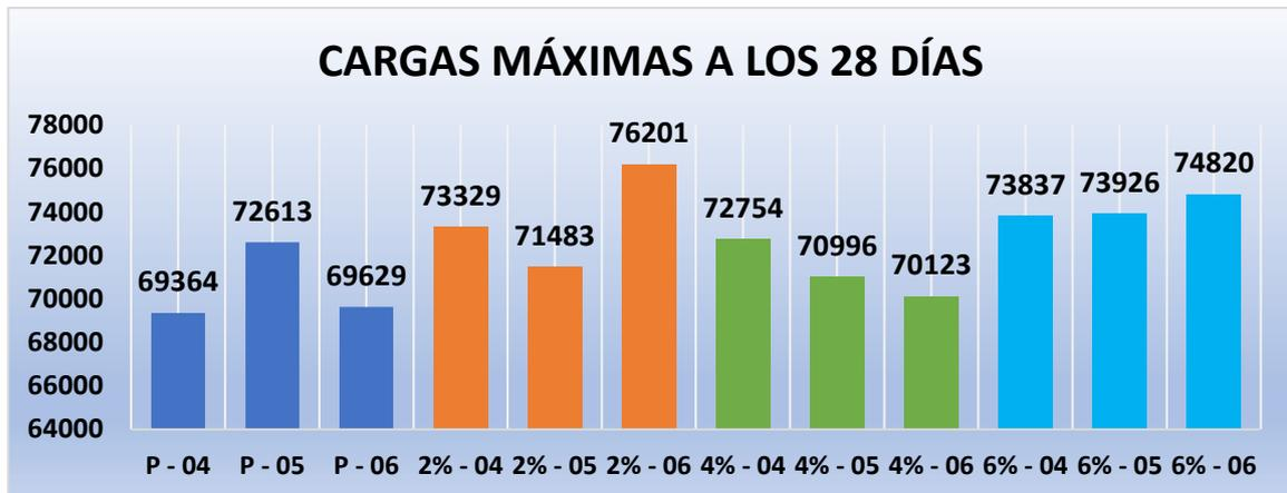
Nota. en el grafico se separó por colores cada diseño de mezcla y muestran las cargas máximas obtenidas en laboratorio
