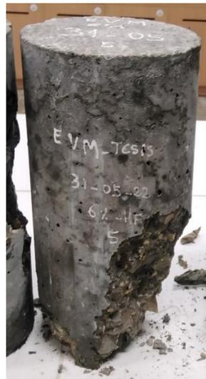
Nota. La fractura de la Probeta Patrón 6% - 05 fue de Tipo 5
