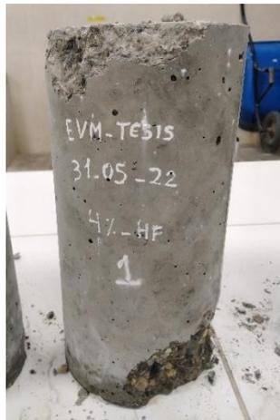
Nota. La fractura de la Probeta Patrón 4% - 01 fue de Tipo 5
