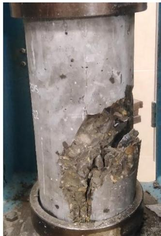
NOTA. La fractura de la Probeta Patrón P - 04 fue de Tipo 5
