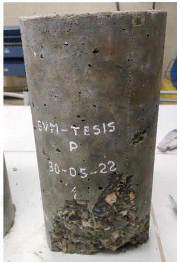
NOTA. La fractura de la Probeta Patrón P – 01 fue de Tipo 5
