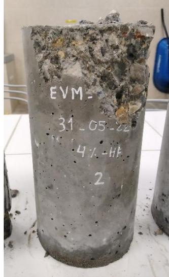
Nota. La fractura de la Probeta Patrón 4% - 02 fue de Tipo 5
