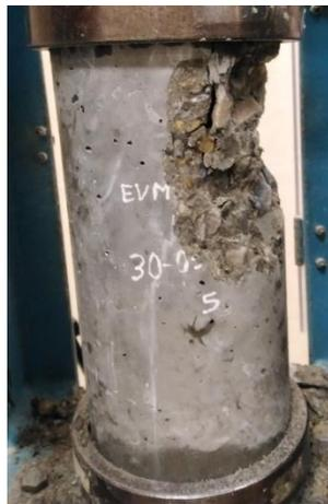
Nota. La fractura de la Probeta Patrón 2% - 05 fue de Tipo 5
