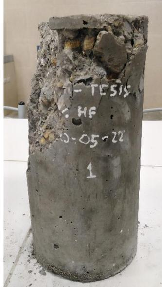
NOTA. La fractura de la Probeta Patrón 2% - 01 fue de Tipo 4
